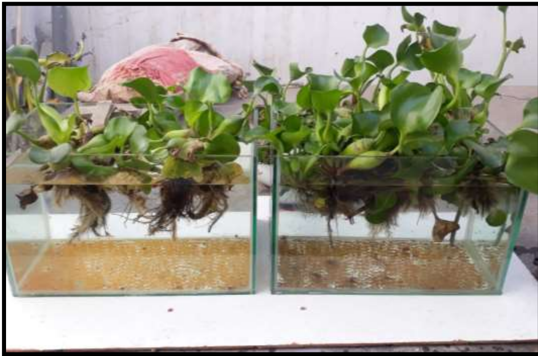
Fotografía 19: Remoción de plomo a los 7 (1° estanque) y 14 días (2° estanque) de exposición con su dosificación respectiva.
