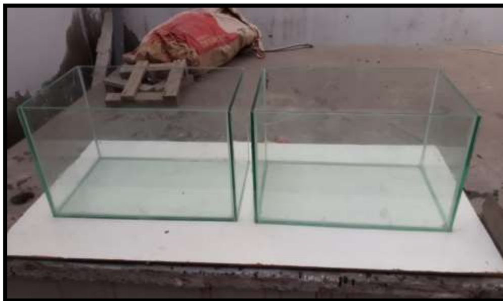
Fotografía 7. Creación de los estanques para el ensayo experimental.
