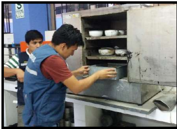
Fotografía N°5: Secado de Arcilla en Horno x24h
