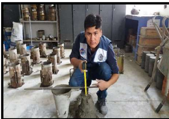
Fotografía N°40-41: Medida de Slump entre 3” a 4”
