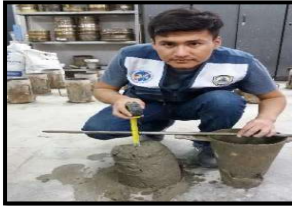
Fotografía N°51-52: Medida de Slump entre 3” a 4”
