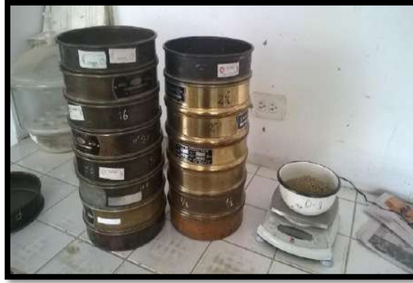
Fotografía N°36: Tamizado Agreg. Grueso
