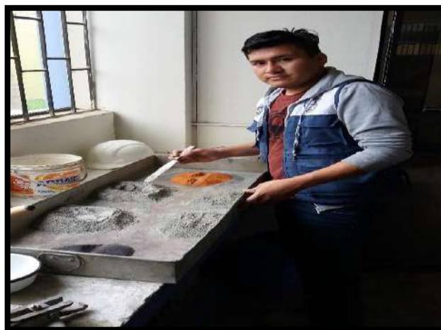
Fotografía N°48: Cuarteo de materiales
