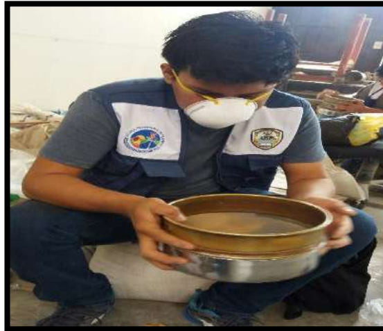
Fotografía N°7: Tamizado de Arcilla por malla #200
