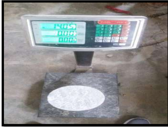
Fotografía N°61: Peso de probetas patrón
