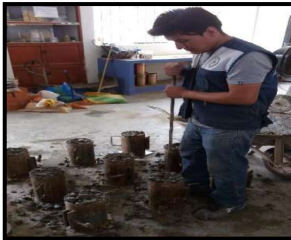
Fotografía N°53: Chuceado del concreto
