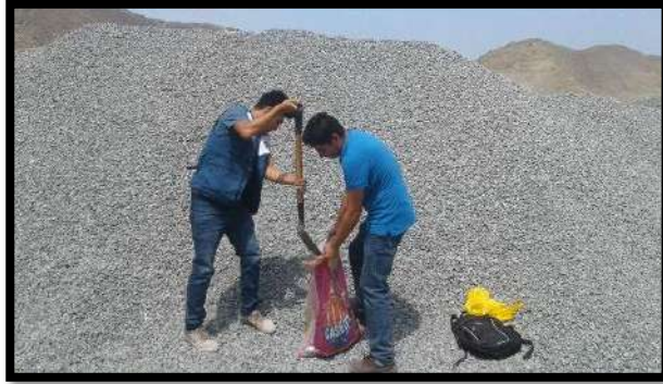
Fotografía N°24: Recolección de agregado grueso
