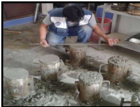
Fotografía N°54: Enrasado del Concreto
