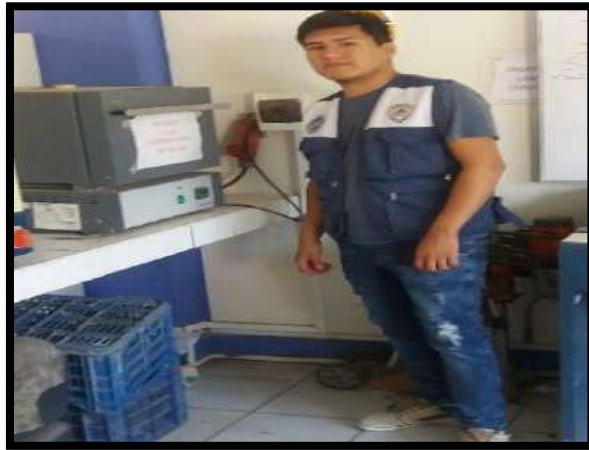
Fotografía N°13: Arcilla en la mufla durante 1 1/2hr. A 530 °C
