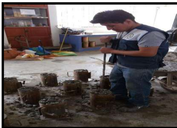
Fotografía N°42: Chuceado de concreto
