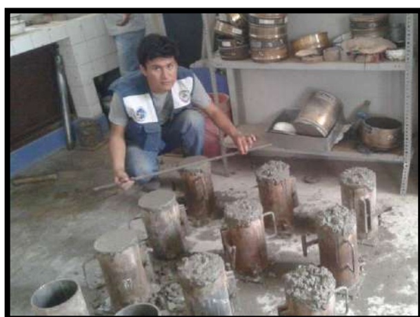
Fotografía N°43: Enrasado del concreto
