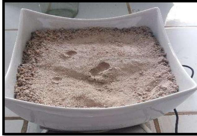
Fotografía N°21-22: Cenizas de cáscara de maní Calcinadas a 530 °C durante 3hrs.
