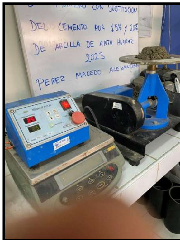
Figura 17. realizando la prueba de fluidez de muestra experimental
