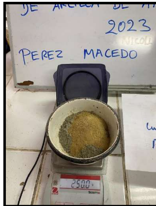
Figura 14. supervisando los pesos de la muestra patrón para la elaboración de los cubos de mortero.
