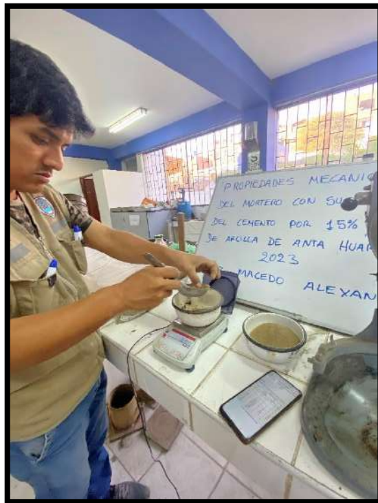
Figura 15. supervisando los pesos de la muestra experimental para la elaboración de los cubos de mortero.
