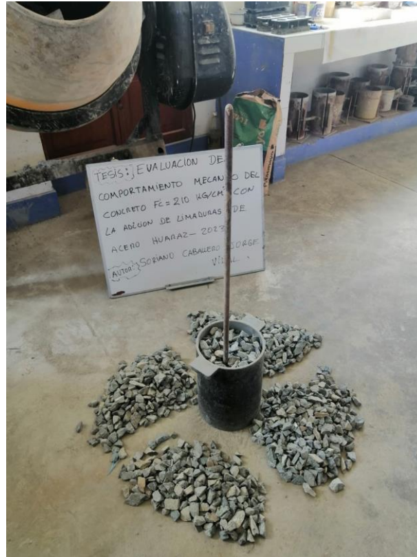
Figura 7: cuarteo de los agregados grueso para ensayos de peso compactado– Laboratorio USP
