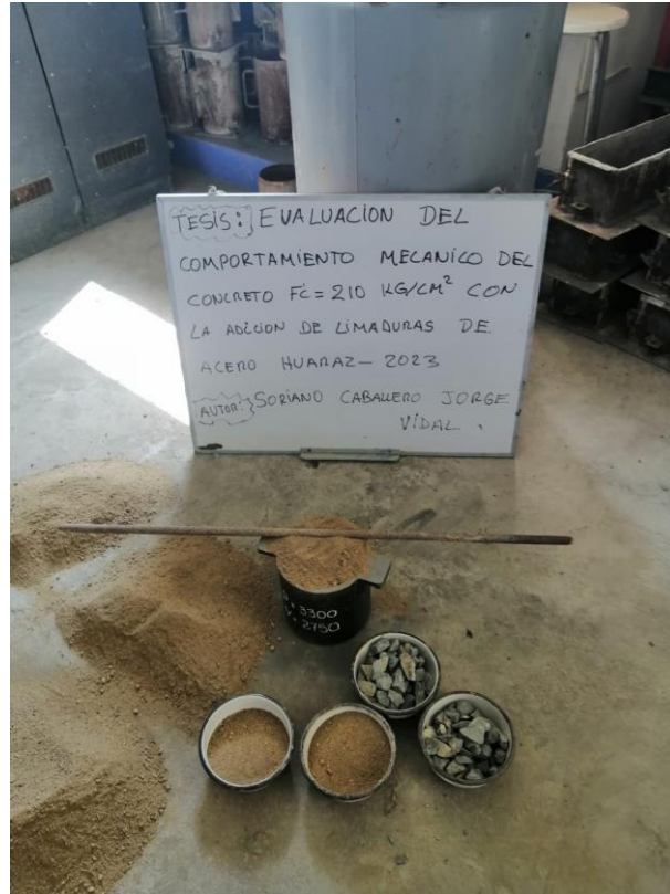
Figura 6: ensayos de peso específico para agregados – Laboratorio USP
