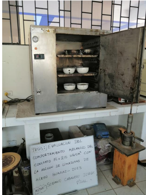
Figura 9: Secado de los agregados para ensayos de contenido de humedad– Laboratorio USP
