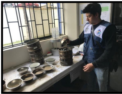
FOTO N° 11: Ensayo de granulometría de los agregados.
