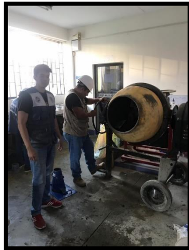
FOTO N° 14: Elaboración de las probetas patrón y experimental del concreto.
