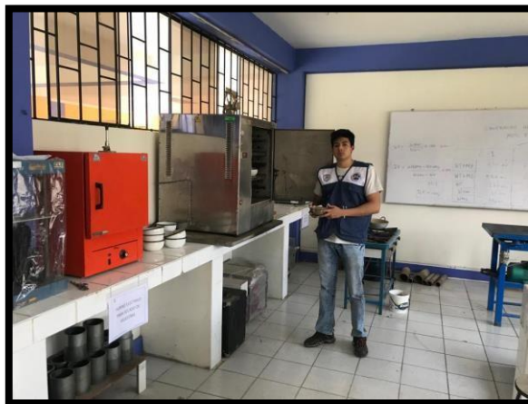
FOTO N° 12: Ensayo del contenido de humedad de los agregados.
