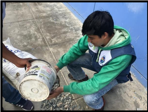
FOTO N° 09: Gradación de la piedra chancada y la arena.
