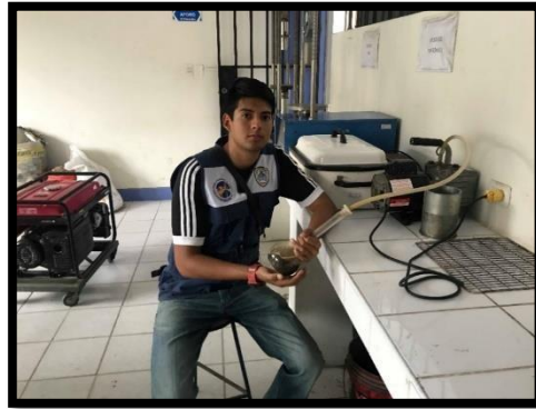
FOTO N° 13 : Ensayo de la Gravedad específica y Absorción de los agregados.
