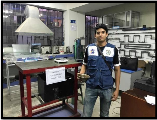
FOTO N° 13 : Ensayo de la Gravedad específica y Absorción de los agregados.
