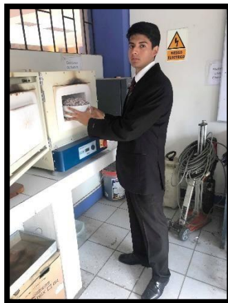
FOTO N° 07: Ingreso de las conchas de abanico a la mufla para su calcinación.
