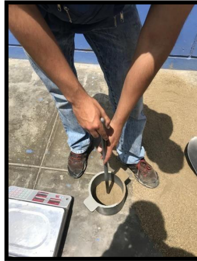
FOTO N° 10 : Ensayo de peso unitario para la piedra y arena.
