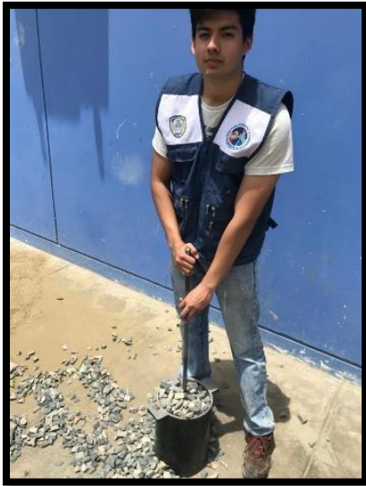
FOTO N° 10 : Ensayo de peso unitario para la piedra y arena.
