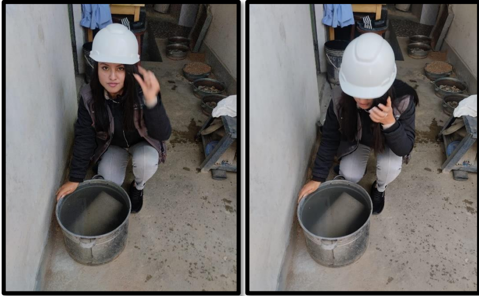
foto 9: curado de briqueta de concreto
