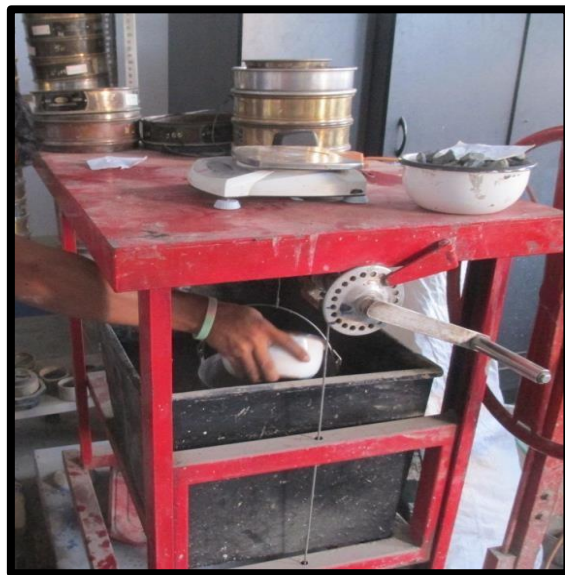
Figura 32. Pesado de muestra seca en agua para ensayo de gravedad específica y absorción
