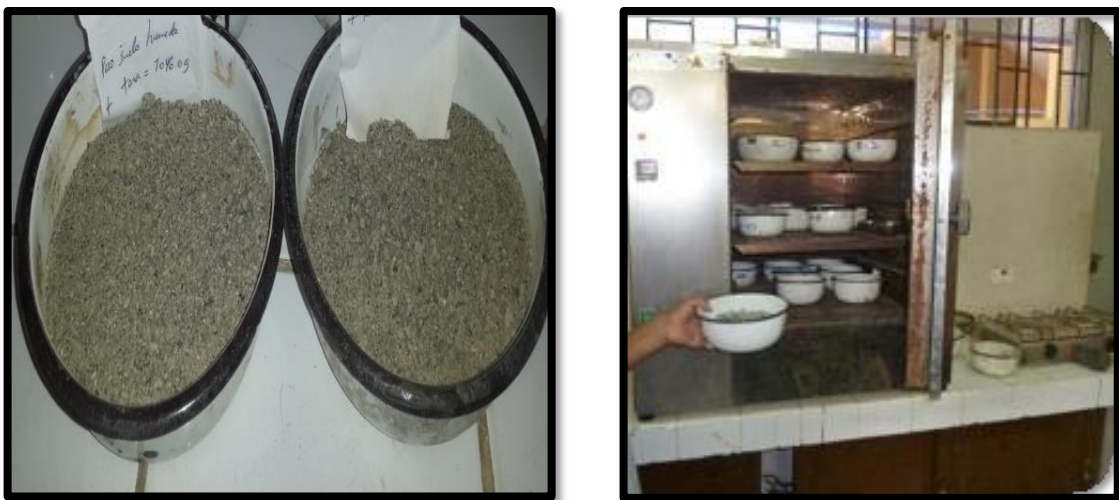
Figura 30. Muestras del agregado para el Ensayo de contenido de humedad.
