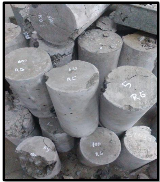
Figura 43. Probetas experimentales ensayadas a la edad de 7, 14 y 28 días
