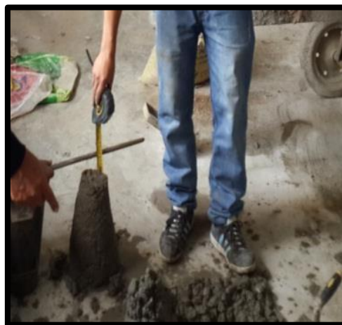
Figura 34. Verificación de asentamiento del cono de Abrams
