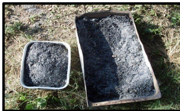
Figura 4: Enfriamiento y Oxigenación de la ceniza en bandeja metálica.
