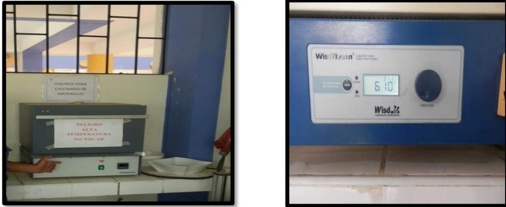
Figura 5: Calcinación de las cenizas de la planta de maíz a tres temperaturas de 500°, 600° y 700°.
