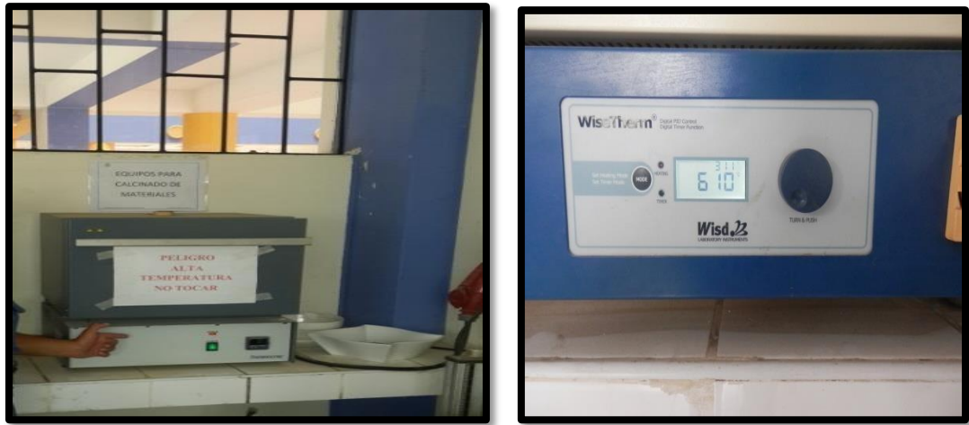
Figura 23. Calcinación de las cenizas de la planta de maíz a tres temperaturas de 500°, 600° y 700°.
