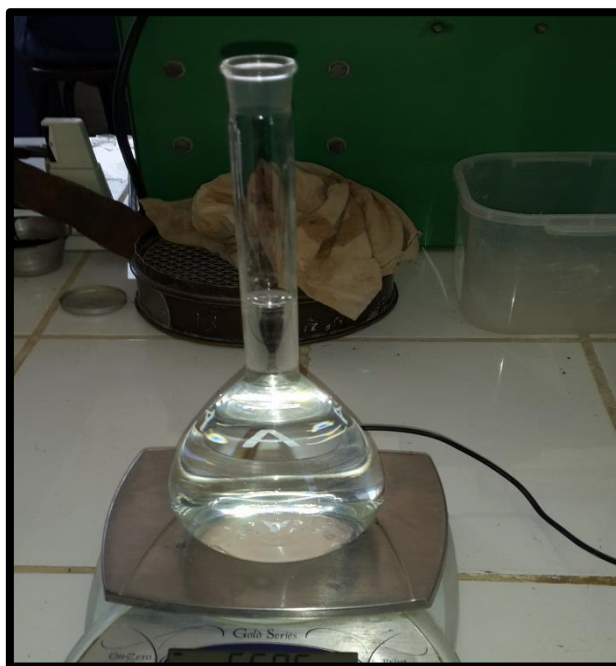
Figura 33. Pesado de picnómetro con agua para ensayo de absorción
