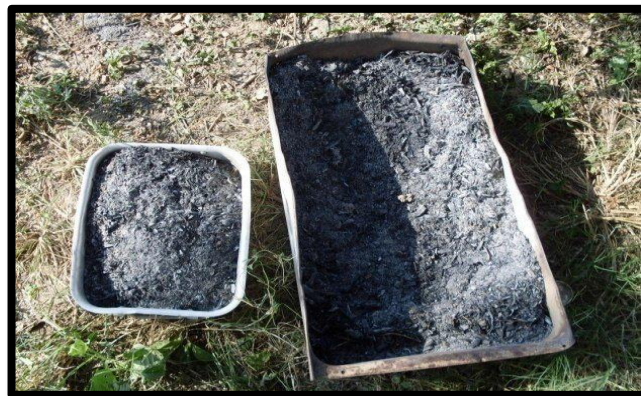
Figura 22. Enfriamiento y Oxigenación de la ceniza en bandeja metálica.
