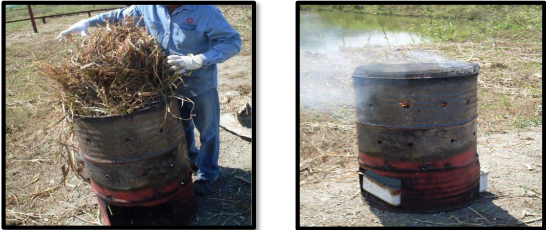
Figura 3: Proceso de prequemado (tiempo aproximado de duración 12 minutos).
