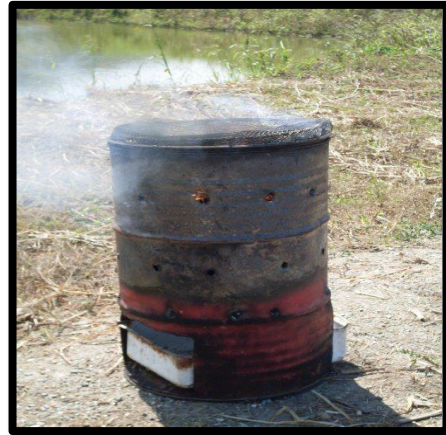
Figura 21. Proceso de prequemado (tiempo aproximado de duración 12 minutos).
