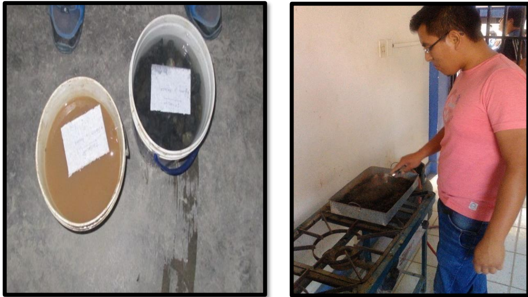
Figura 31. Muestras de agregados en agua para ensayo de gravedad específica y absorción
