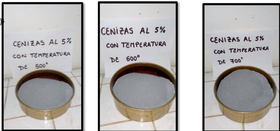
Figura 6: Tamizado de las cenizas de la planta de maíz por la malla N° 200.
