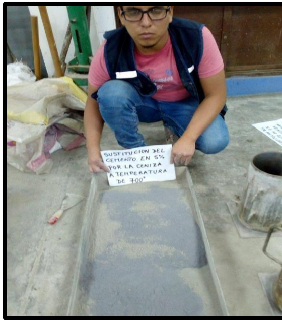
Figura 37. Mezclando el cemento con las cenizas de la planta de maíz a las tres temperaturas (500, 600 y 700°)
