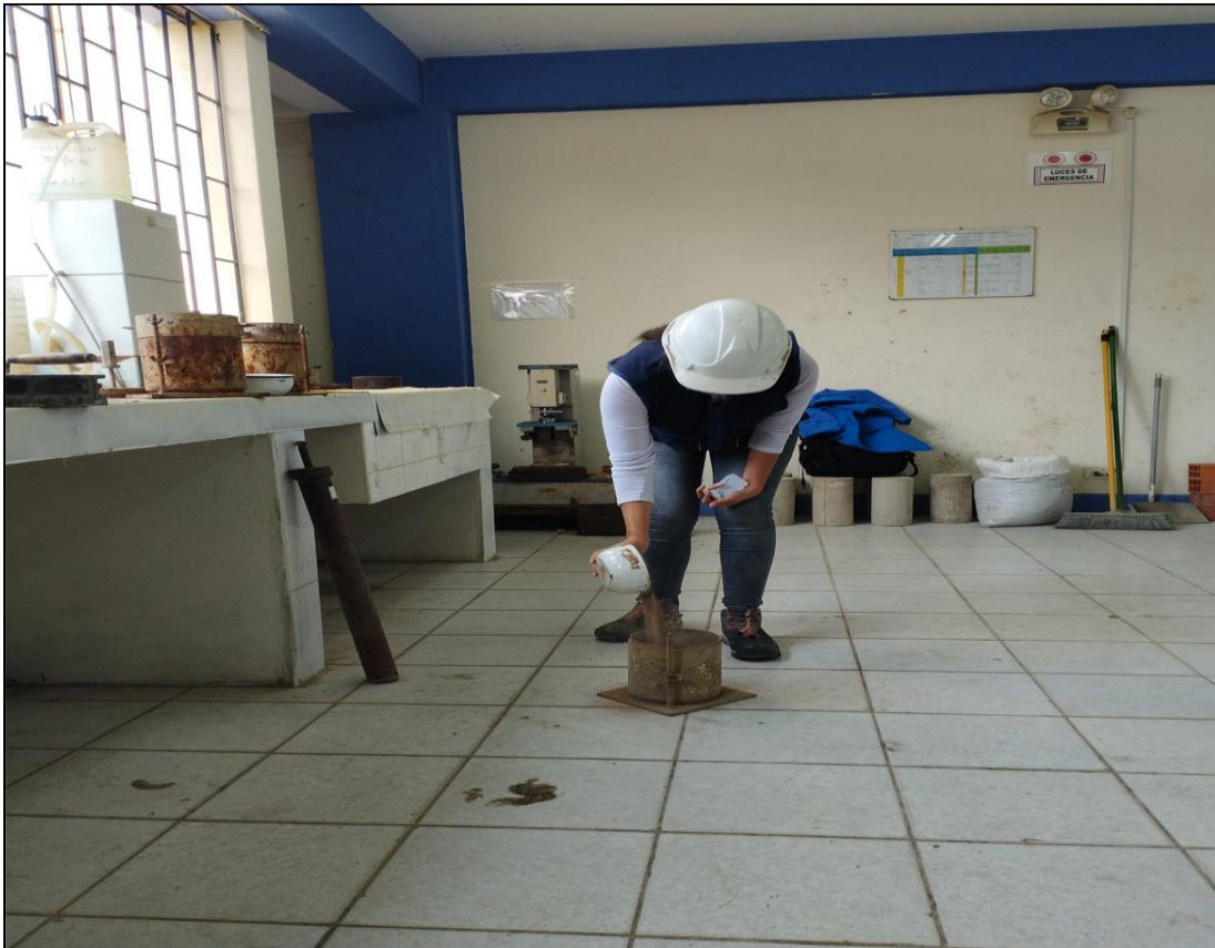
Imagen 03: vaciado del material en un anillo de metal para su compactación
