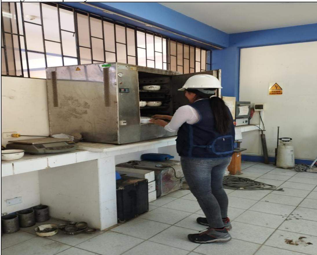
Imagen:06. Puesto de la muestra en horno para el secado a 110°C
