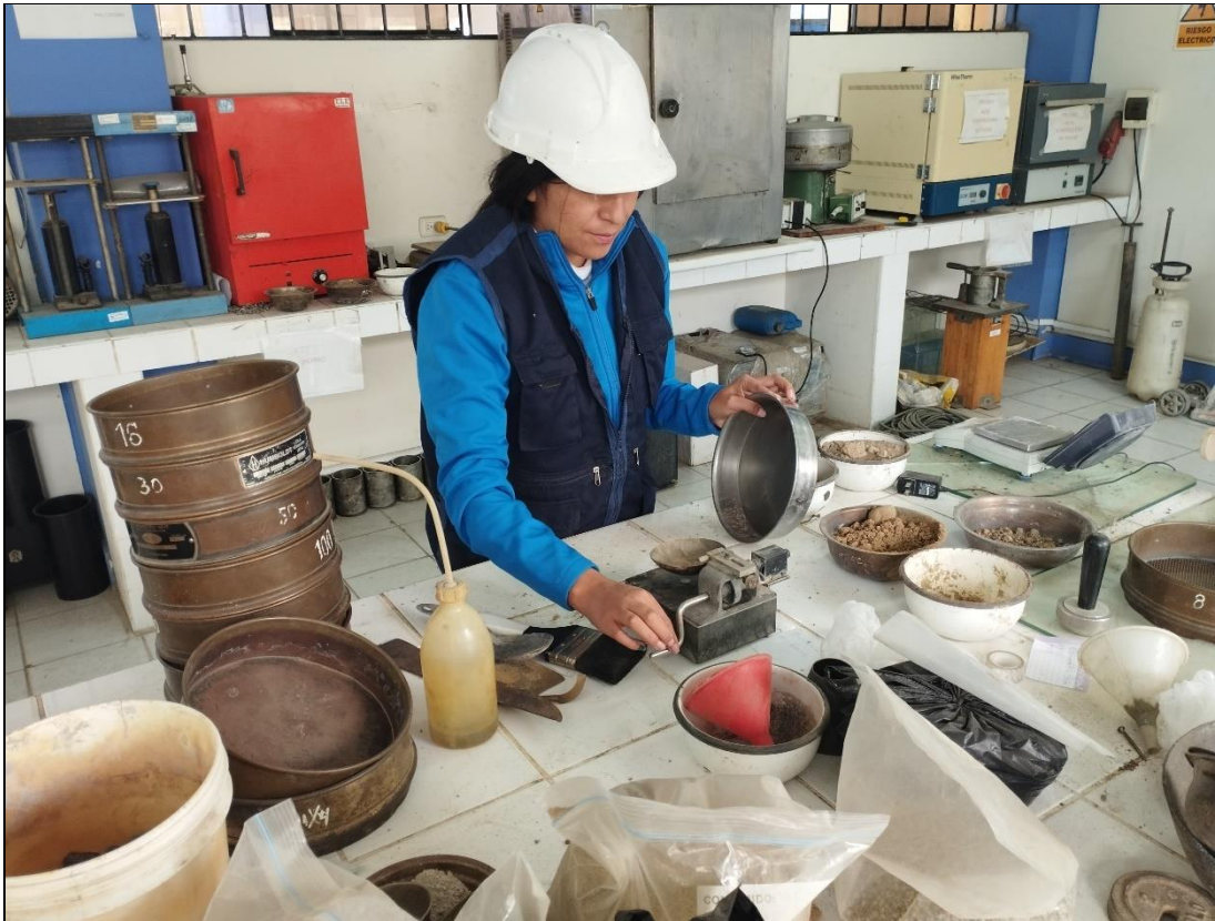
Imagen:07. Muestra de suelo en la cuchara de Casagrande antes y después del ensayo
