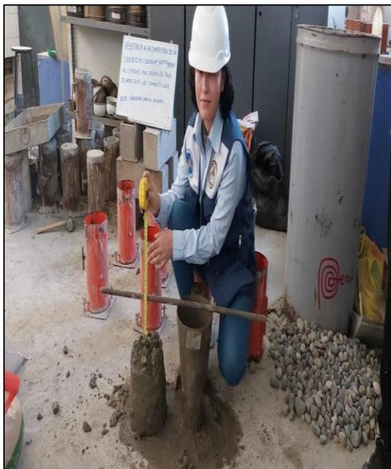
Figura 15: Ensayo de Slump y elaboración de probetas.
