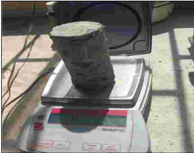
Foto 11. Pesaje de muestra de concreto del Jr. Mariscal Luzuriaga.
