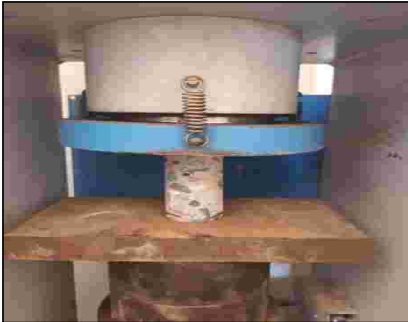
Foto 15. Muestra lista para su rotura.
