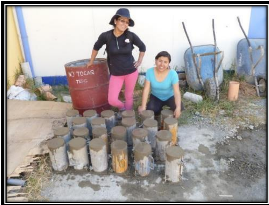
Fotografía N° 08: Probetas realizadas con porcentajes de Relave Minero
