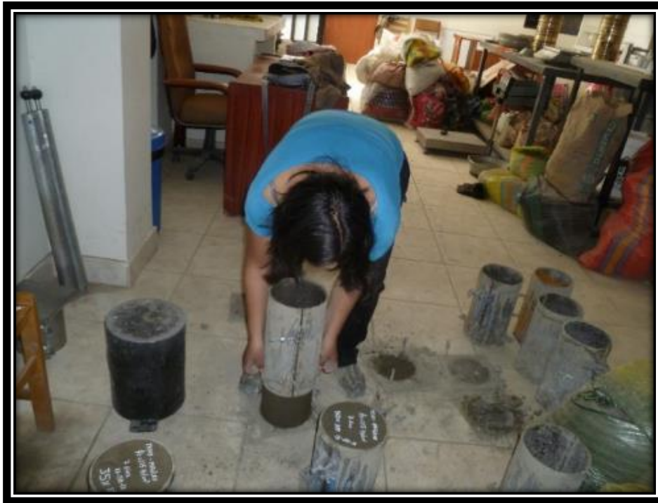
Fotografía N° 09: Desencofrado de las probetas rotuladas.
