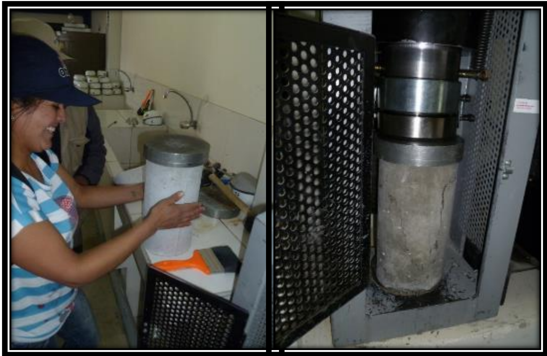
Fotografía N° 13: Ensayo de Compresión
