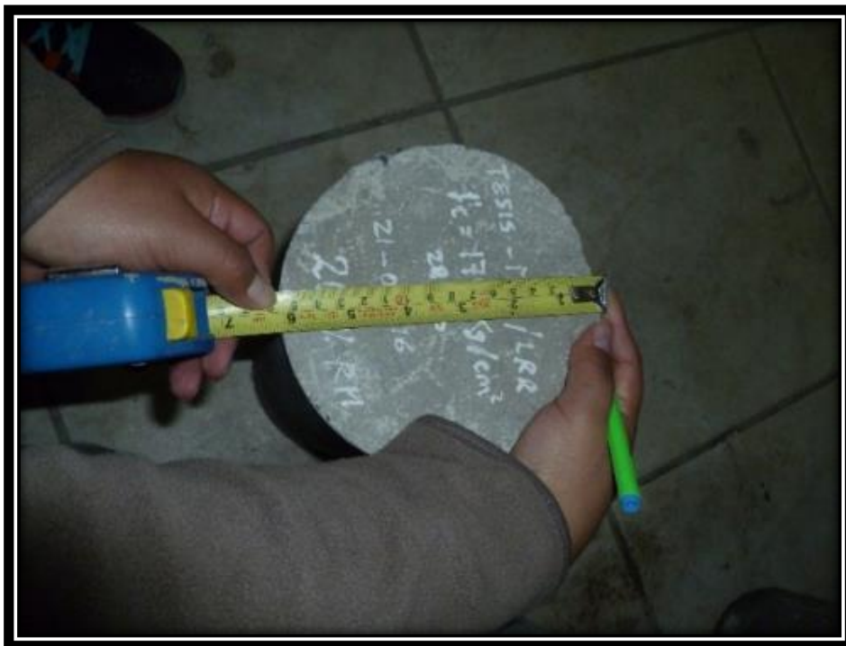
Fotografía N° 12: Medición de los diámetros de las probetas
