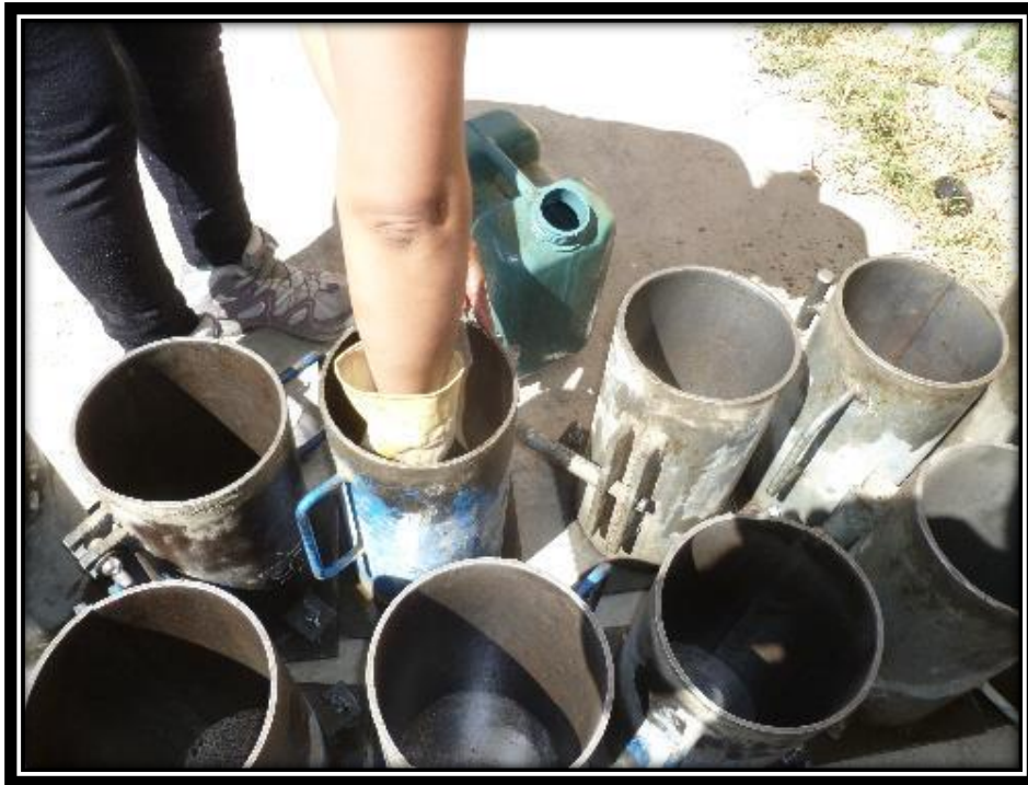
Fotografía N° 05: Limpieza de los moldes.
