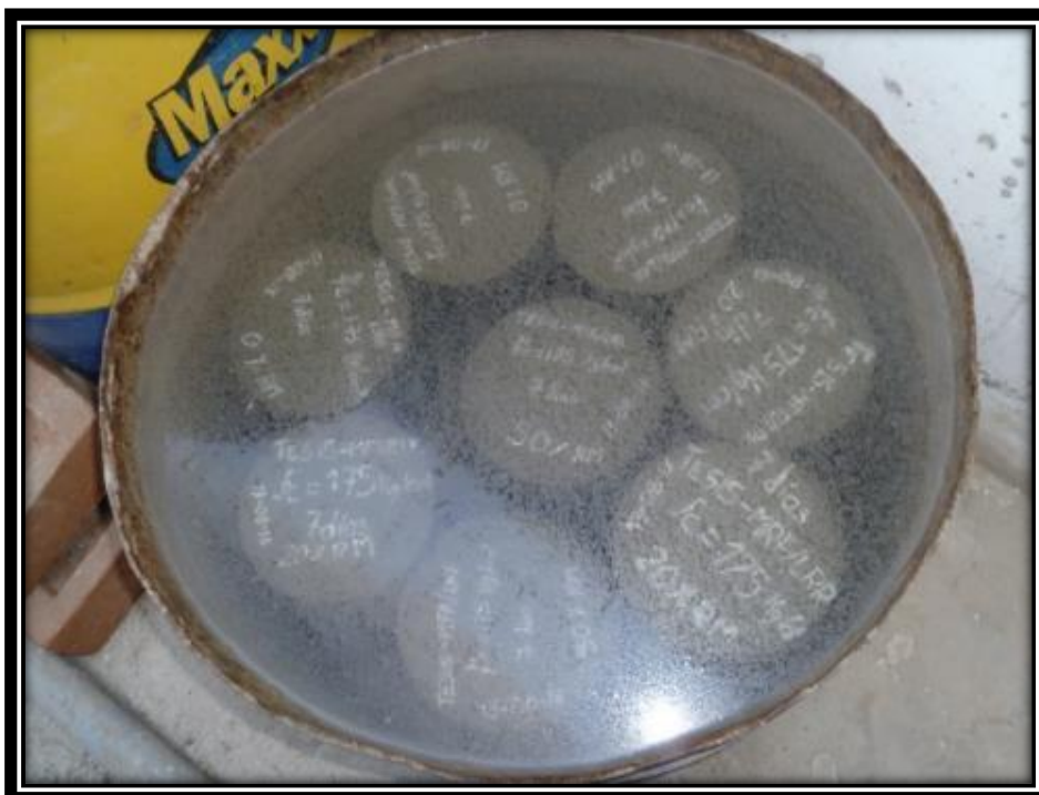
Fotografía N° 10: Curado de los testigos de concreto
