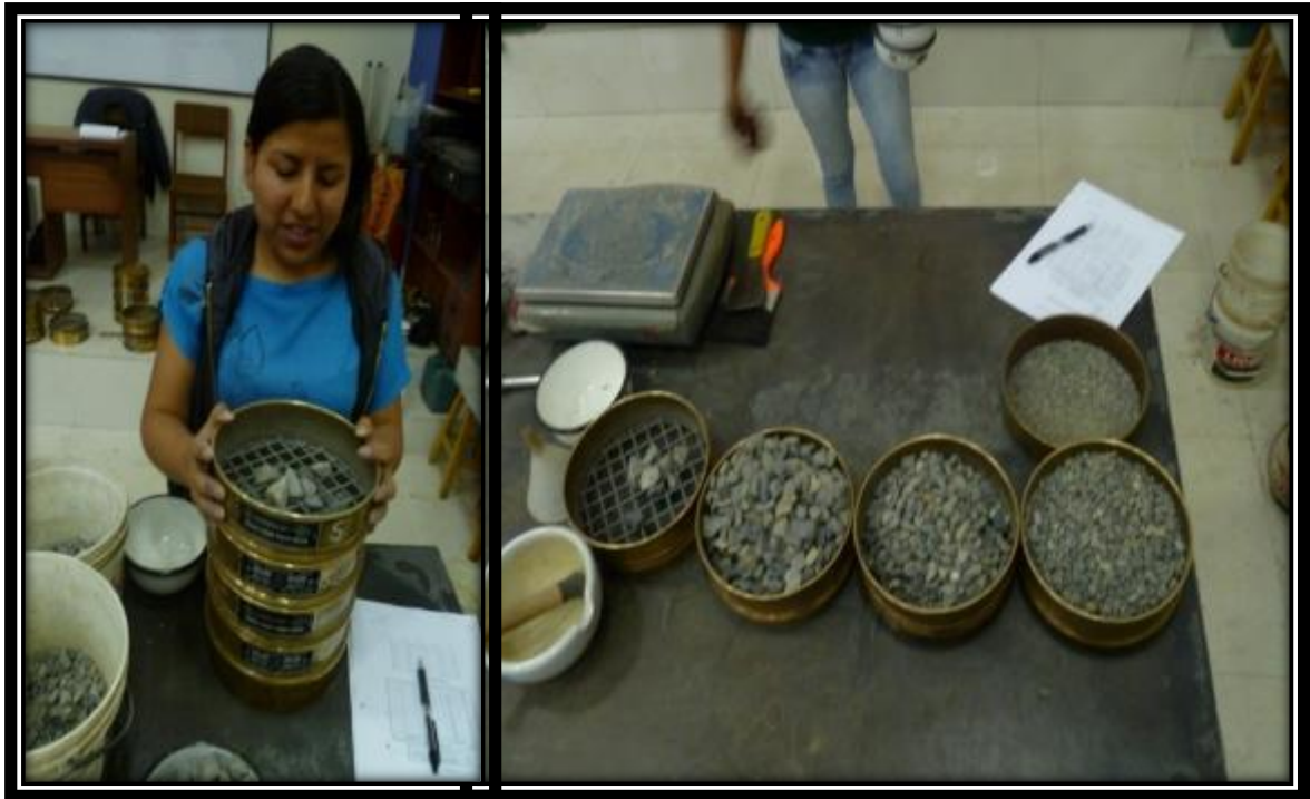
Fotografía N° 03: Ensayo de Análisis granulométrico
