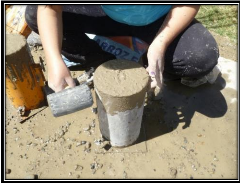
Fotografía N° 07: Eliminación de aire mediante el golpeado con martillo de goma.
