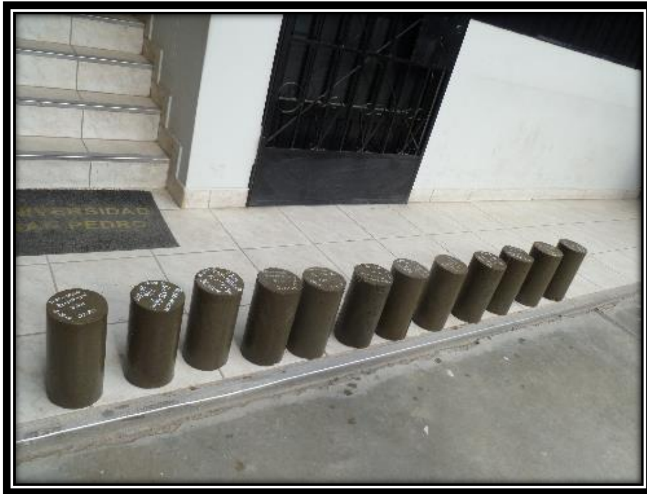
Fotografía N° 11: Secado de los testigos, antes de iniciar la pruebas de compresión.
