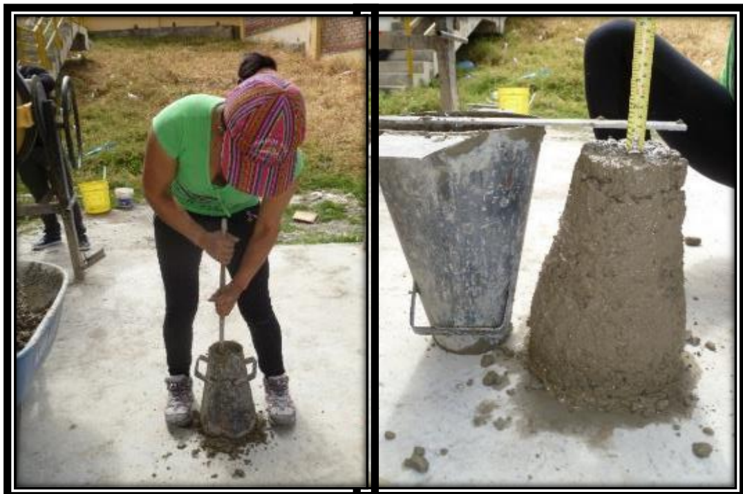
Fotografía N° 04: Prueba Consistencia del Concreto (Cono de Abrams)
