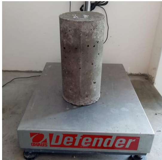
Figura N° 15: peso de las probetas patrón y experimentales
