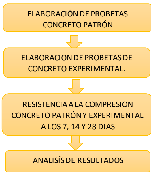
Figura 15: Esquema para la elaboración del concreto
