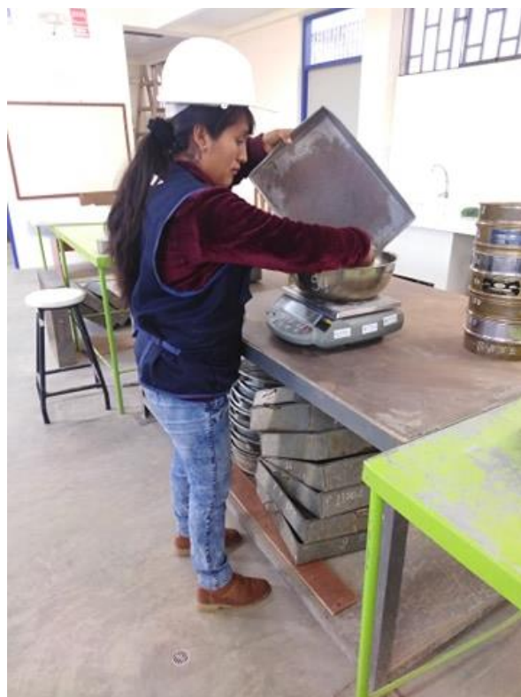
Figura N° 03: pesado del agregado fino.
