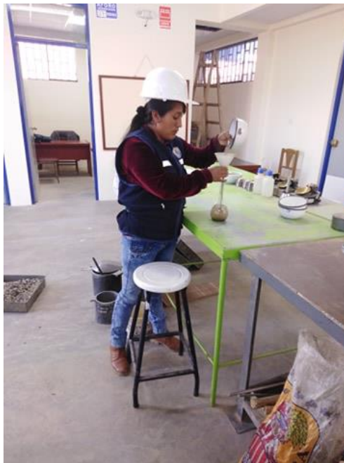
Figura N° 05: peso específico de agregado fino.
