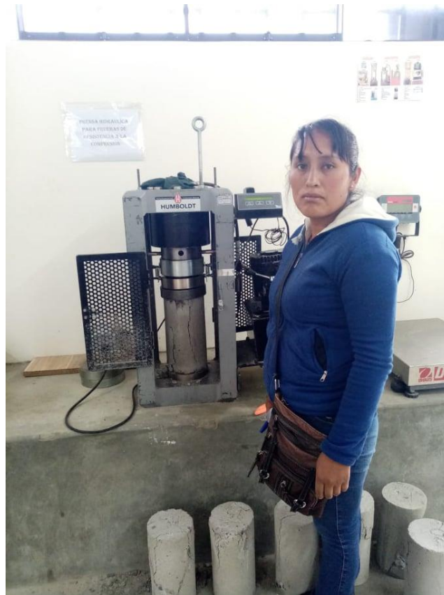
Figura N° 16: resistencia a compresión de las probetas.
