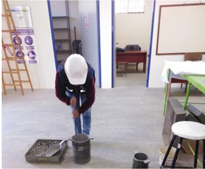
Figura N° 06: ensayo de peso unitario compactado.
