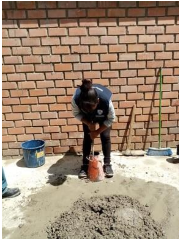
Figura N° 10: slump de patrón.
