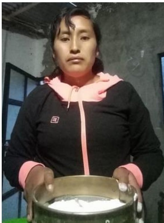
Figura N° 08: Tamizado por la malla N°200 cascara de huevo
