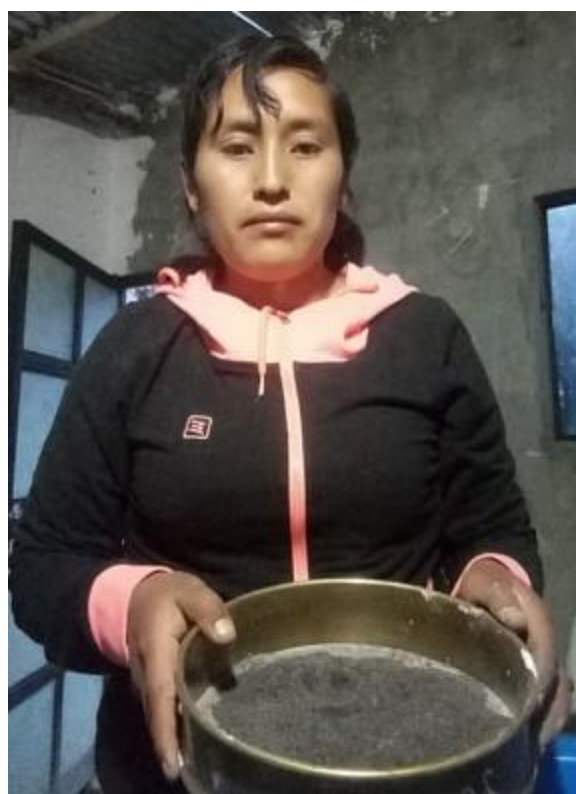
Figura N° 09: Tamizado por la malla N°200 paja de trigo.
