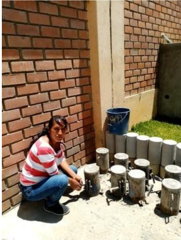
Figura N° 13: desencofrado de las probetas patrón y experimental.
