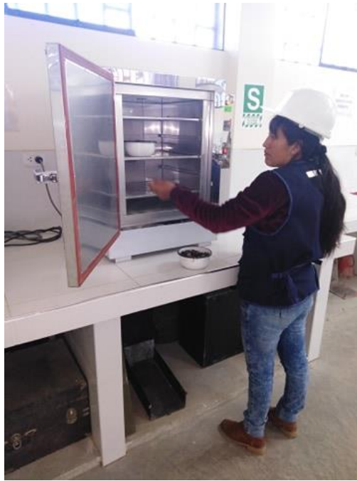
Figura N° 04: Secado de muestras en horno.
