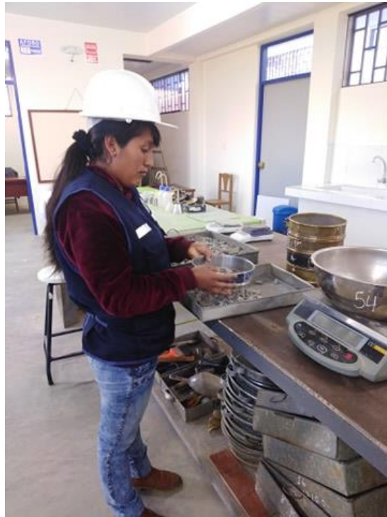
Figura N° 02: proceso de tamizado de agregado grueso.
