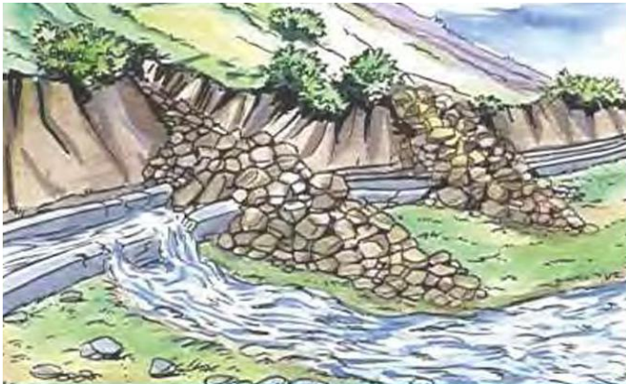
Figura 3: Deslizamiento y Colmatación de Rocas en canal de conducción
