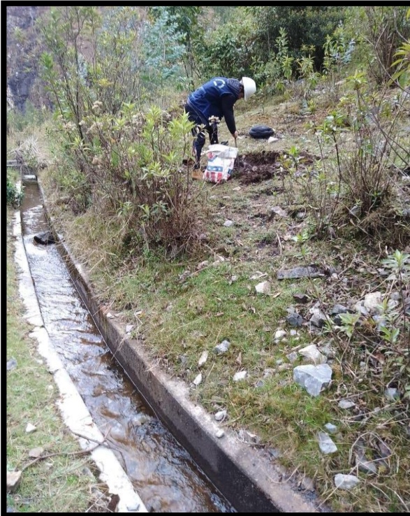
Anexo 01: Excavación de la calicata para el Estudio de suelos 2m.
