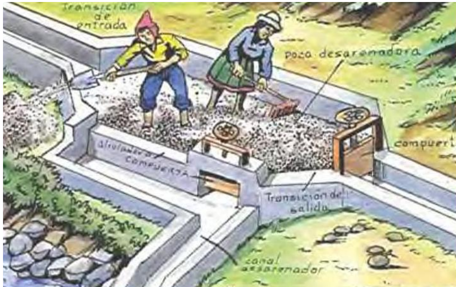
Figura 7: Limpieza de la poza del desarenador
