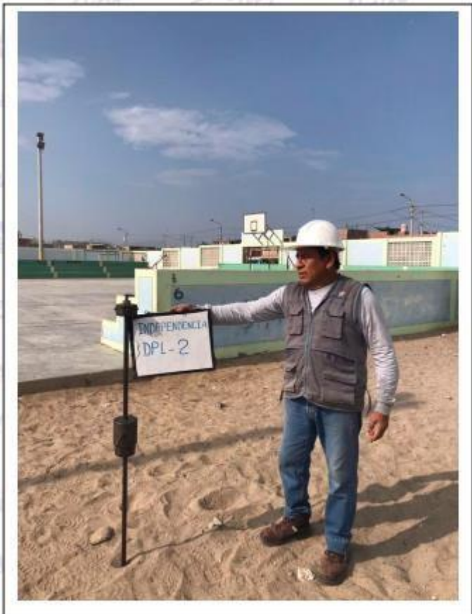
Foto N°06: Vista de la ubicación de la auscultación DPL-02, de compacidad media a muy densa.
