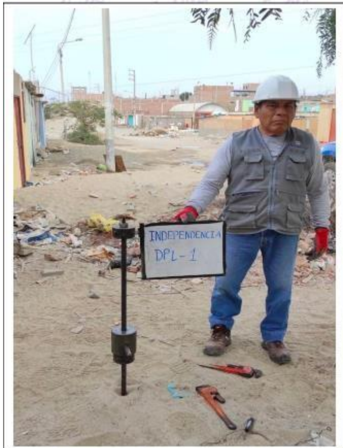
Foto N°04: Vista de la ubicación de la auscultación DPL-01, de compacidad media a muy densa.
