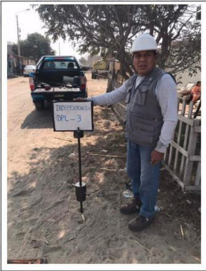
Foto N°08: Vista de la ubicación de la auscultación DPL-03, de compacidad media a muy densa.
