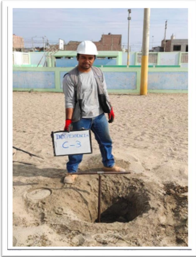
Foto N°05: Vista de ubicación de la calicata C-03, presencia de suelo natural, Arena Mal Graduada con Limo, con presencia de grava aislada de 0.00 a 0.15m.; seguido de un suelo Arena Mal Graduada con Limo (SPSM), seca a ligeramente húmeda, de compacidad media a muy densa, de color beige claro.
