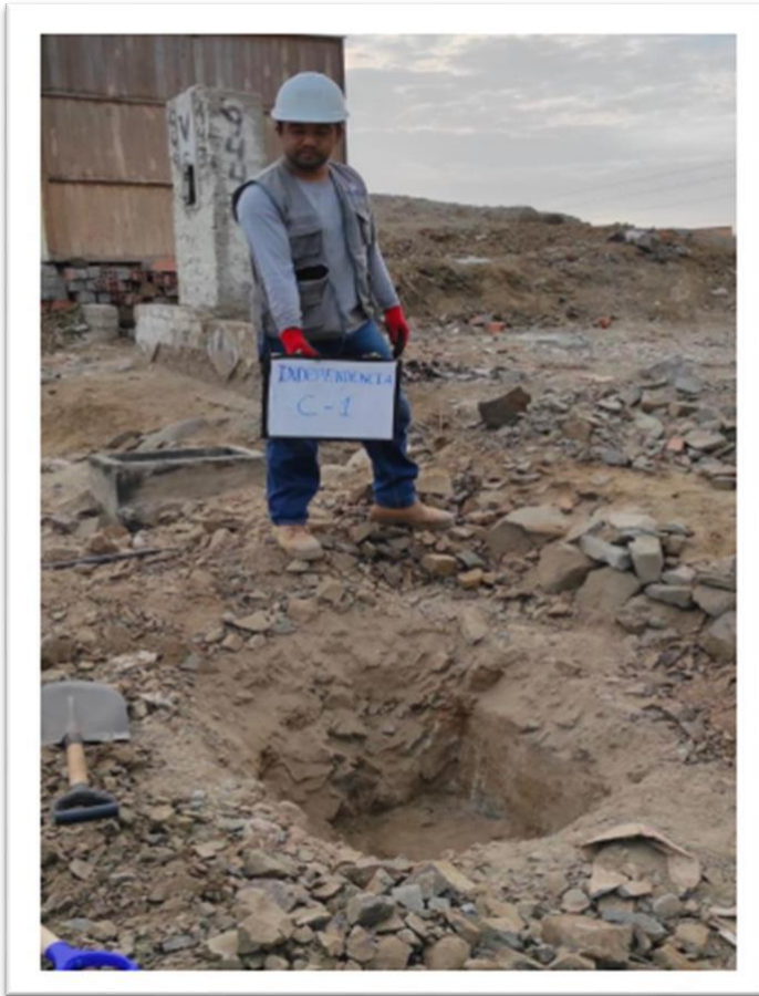
Foto N°01: Vista de calicata C-01, presencia de suelo natural con gravas angulosas, suelto, roca meteorizada y resto de material plástico de 0.00 a 0.35 m.; seguido de roca meteorizada de 0.35 a 0.65m.; y de 0.65m a profundidad es roca maciza.
