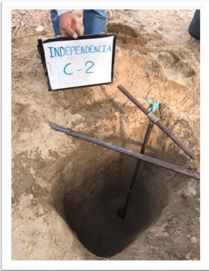
Foto N°03: Vista de ubicación de la calicata C-02, de 0.10 a 3.00m. siendo un suelo Arena Mal Graduada con Limo (SP-SM), seca a ligeramente húmeda, de compacidad media a muy densa, de color beige claro.
