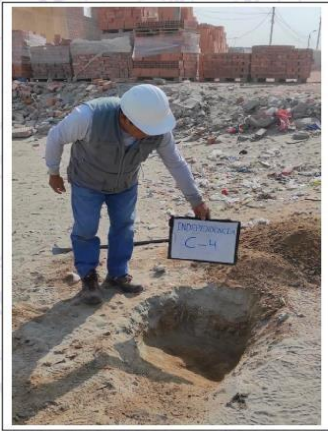
Foto N°07: Vista de calicata C-04; Arena Mal Graduada con Limo (SP-SM), seca a ligeramente húmeda, de compacidad media a muy densa, de color beige claro de 0.10 a 0.40m.; seguido de roca meteorizada de 0.40m a profundidad roca maciza.
