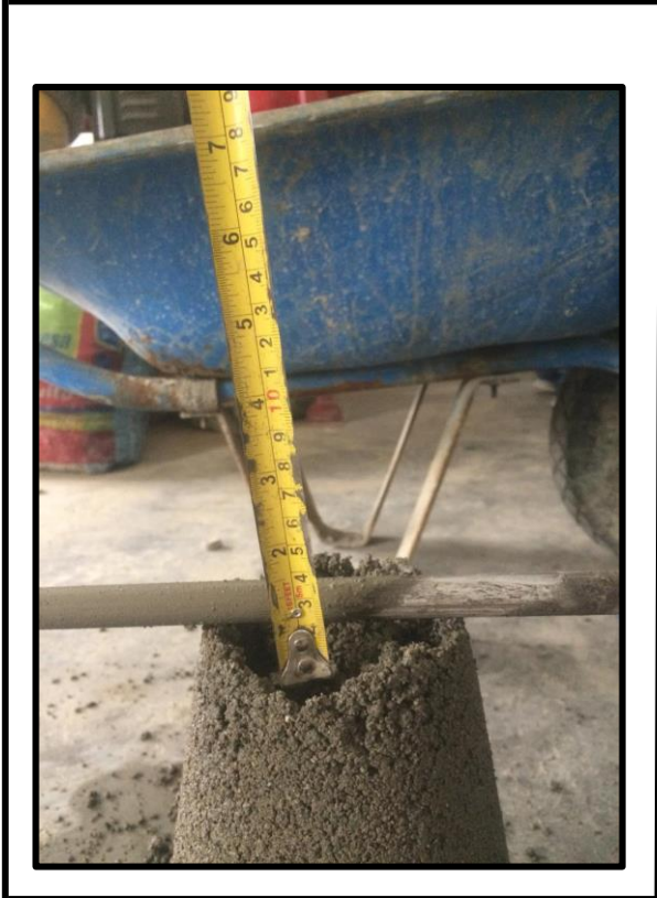
Figura 22. Ensayo al concreto fresco (asentamiento) a la mezcla patrón
