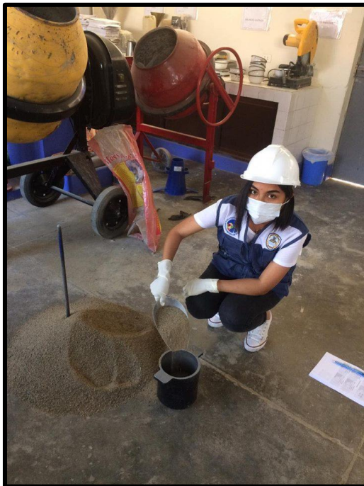
Figura 20. Realizando el ensayo de peso unitario suelto y compactado de la arena y piedra
