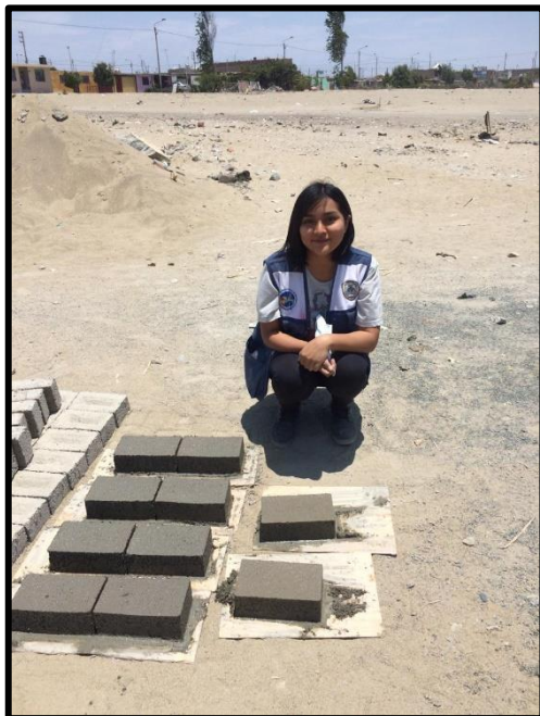
Figura 28. Ladrillos fraguando sobre un triplay
