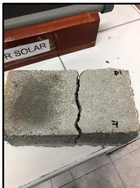
Figura 31. Ladrillo patrón de 7 días luego del ensayo a compresión
