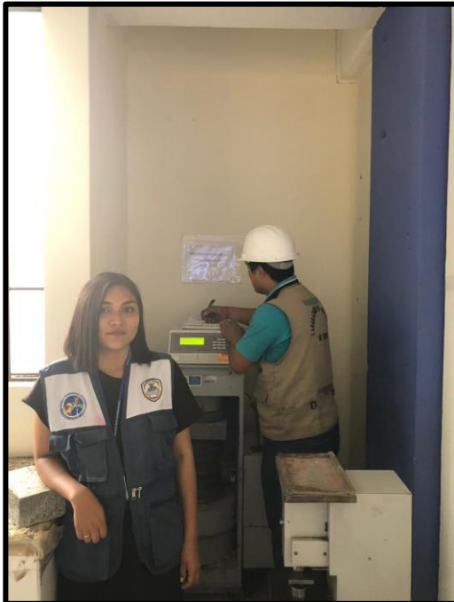
Figura 33. Ensayo a la compresión de los ladrillos patrón y experimentales
