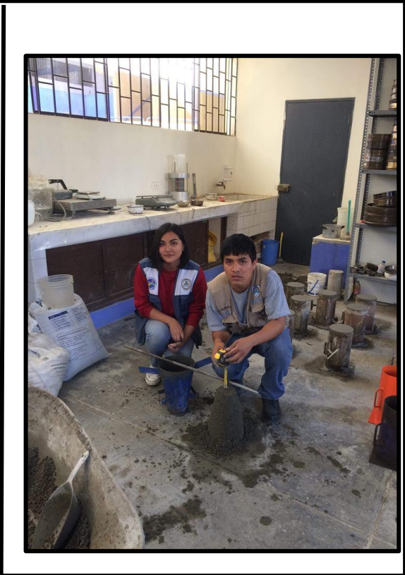
Figura 23. Ensayo al concreto fresco (asentamiento) a la mezcla experimental.
