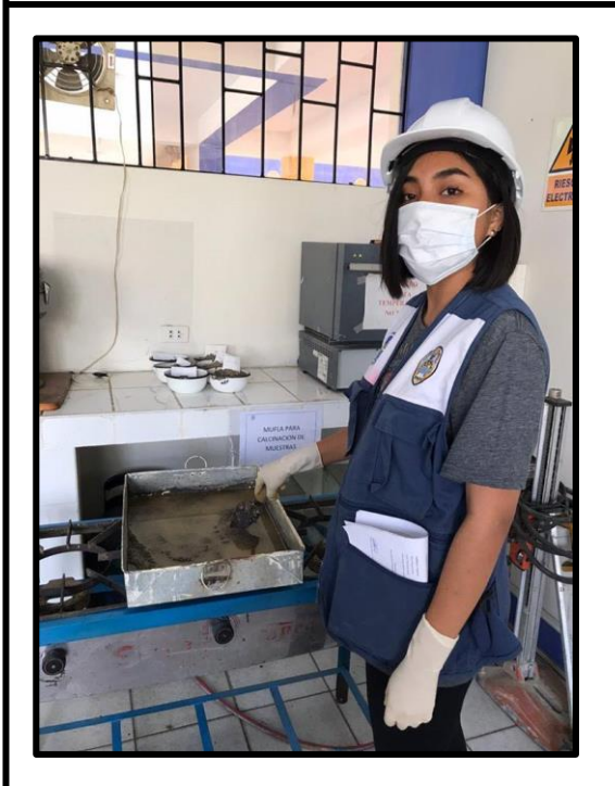
Figura 16. Secado de arena saturada para ensayo de peso específico
