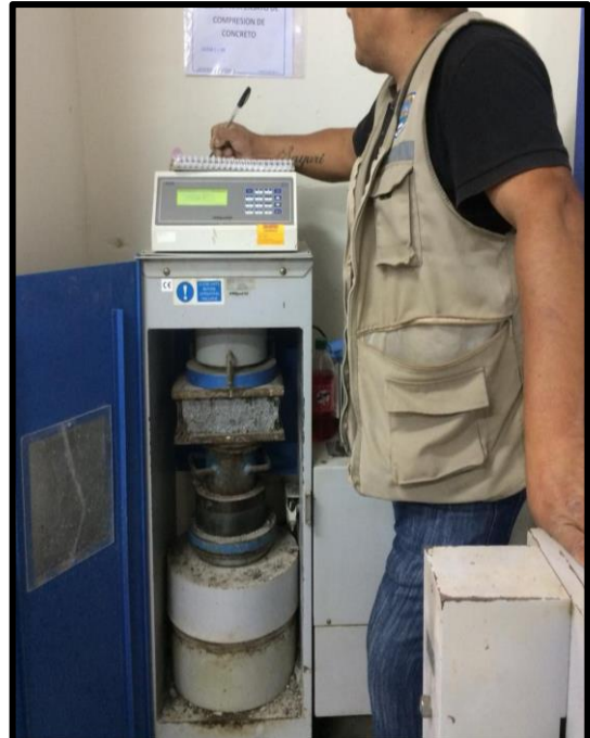
Figura 33. Ensayo a la compresión de los ladrillos patrón y experimentales
