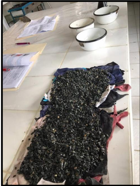
Figura 18. secando superficialmente la piedra previamente saturada
