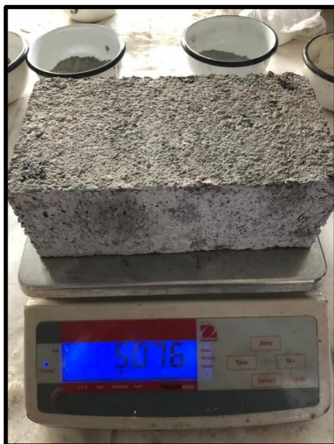
Figura 30. Pesaje de los ladrillos antes de la rotura
