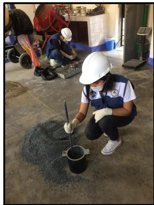
Figura 20. Realizando el ensayo de peso unitario suelto y compactado de la arena y piedra
