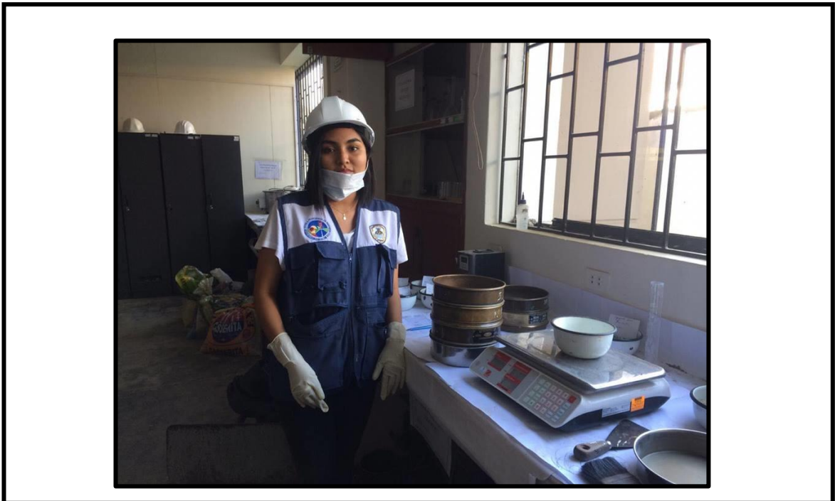
Figura 15. Ensayo de granulometría de la arena y piedra chancada
