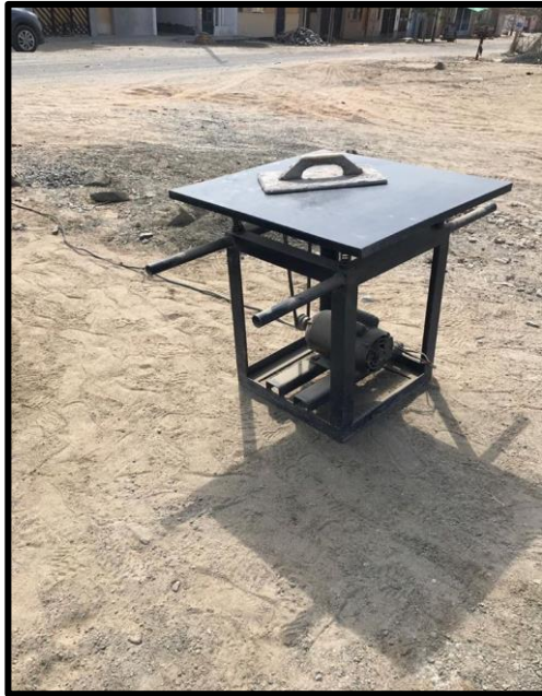
Figura 24. Mesa vibradora que se usó para la fabricación de los ladrillos
