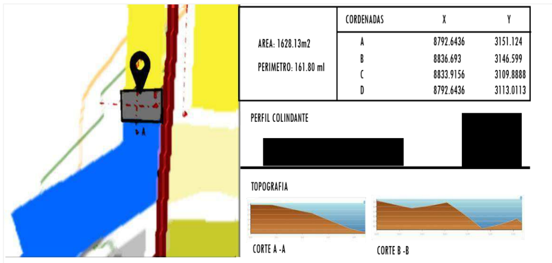
Figura 9. Área, uso de suelo colindantes, perímetro, topografía, coordenadas y perfiles urbanos del terreno seleccionado para el diseño de la estación de bomberos.
