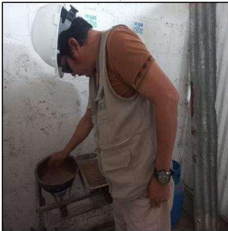
Anexo 2. Vista del ensayo Humedad Natural
