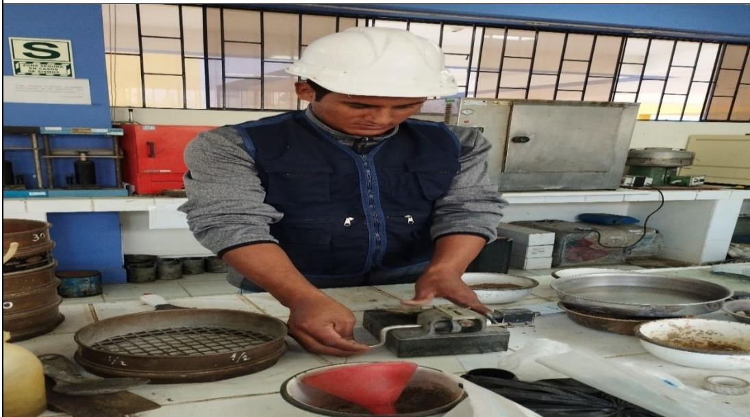
Imagen 08: muestra de suelo en la cuchara de casagrande antes y despues de realizar el ensayo
