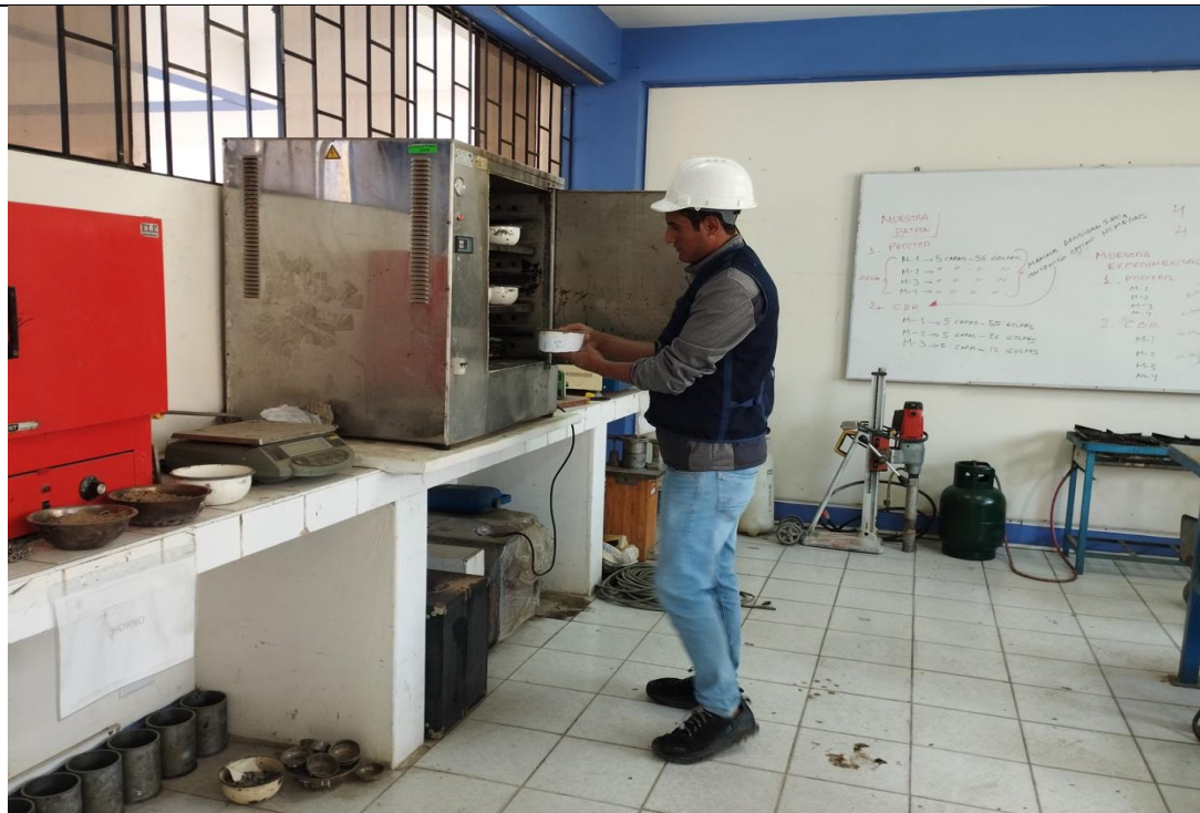
Imagen 06: muestra puesta en horno para el secado en tason metalico a 110°C
