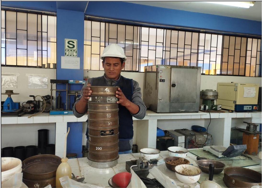
Imagen 02: echado de muestra en los moldes para su respectivo tamizado
