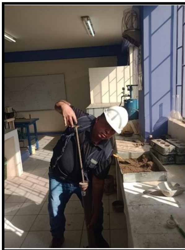
Figura 7. Se procedió a compactando 25 golpes por capa, con el martillo de 10 libras de peso y una caída de 18 pulgadas.
