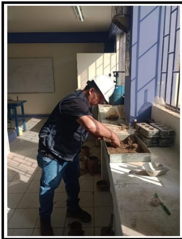
Figura 4. Llevando las muestras al horno para su respectivo secado a una temperatura de 110\text{ }^{\circ}\text{C} \pm 5 .
