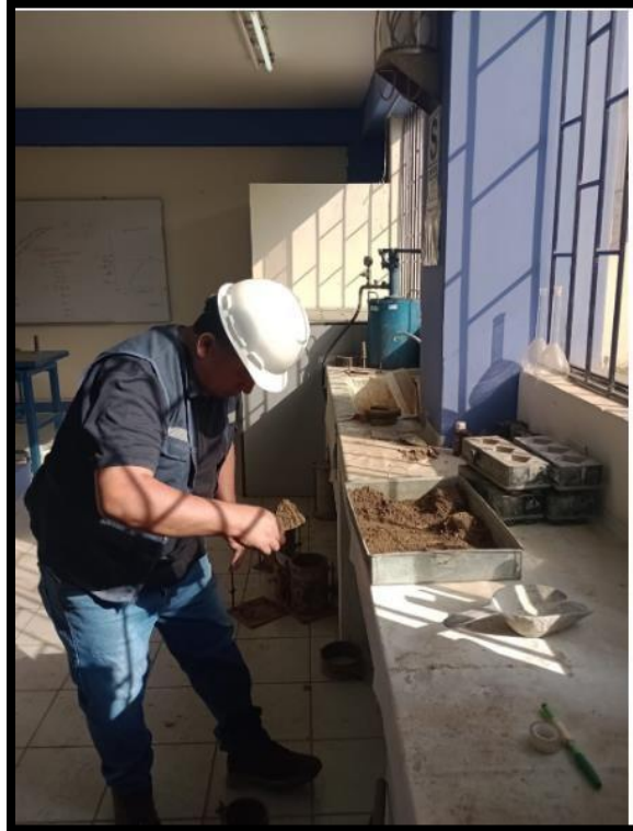
Figura 6. Agregando las muestras en el molde de 4 pulgadas de diámetro para el proctor modificado método A.
