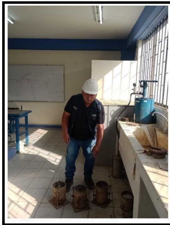
Figura 9. Realizando el CBR, con los datos del proctor modificado.
