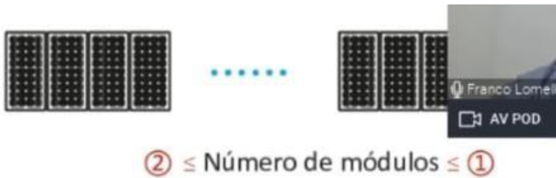
Figura 9. Cantidad de módulos fotovoltaicos por cadena (String).
