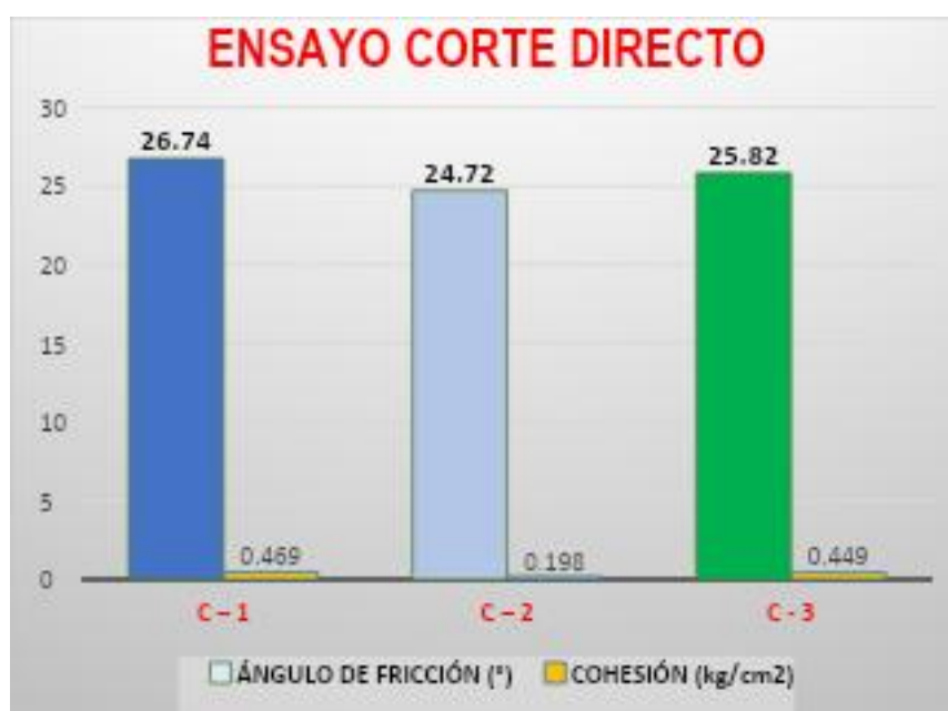
Figura 3. Análisis del ensayo de corte directo en Caserio de Auquipampa
