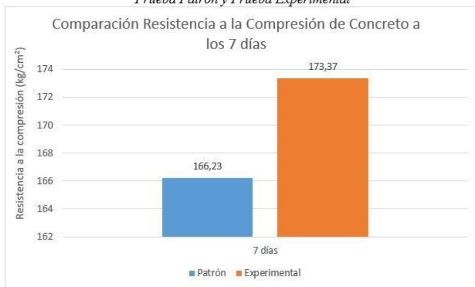
Gráfico N°12: Comparación a los 7 días de la Resistencia a la Compresión en Prueba Patrón y Prueba Experimental
