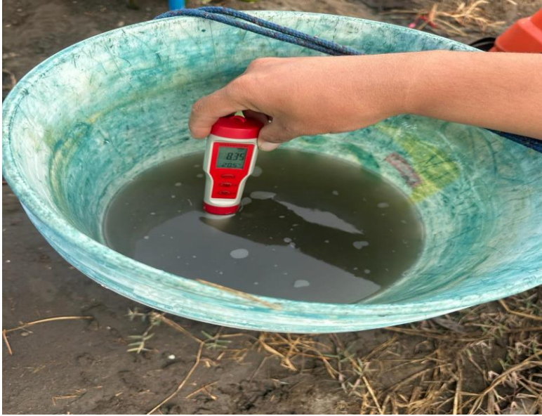
Figura 3. Medición del PH del agua antes de realizar la solución.
