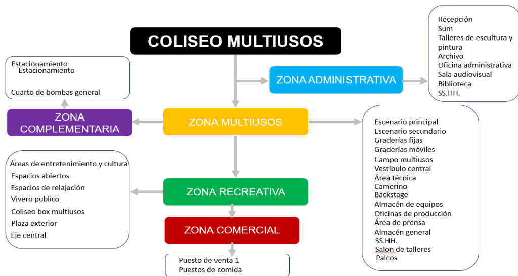
Figura 35. Organigrama de funcionamiento general con sus respectivos ambientes que contiene cada zona.
