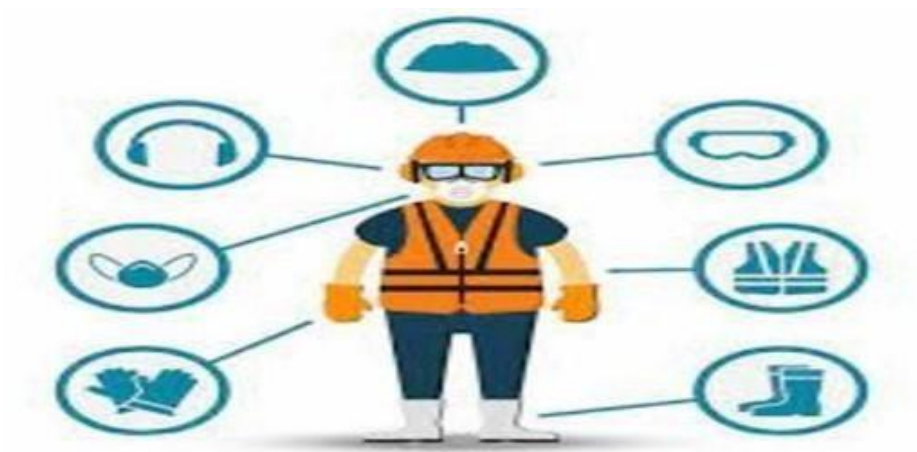
Figura N° 03: Equipos de protección personal.
