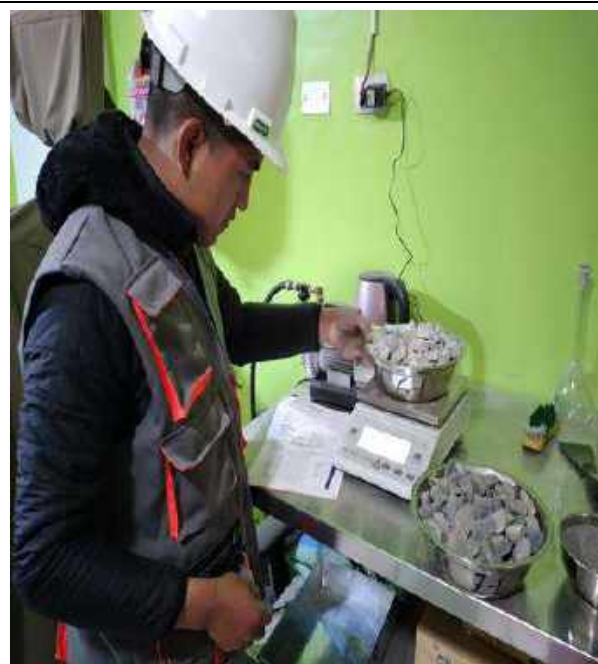
Cuarteo de la muestra y pesado de muestra representativa para el ensayo de contenido de humedad, del agregado grueso reciclado.
