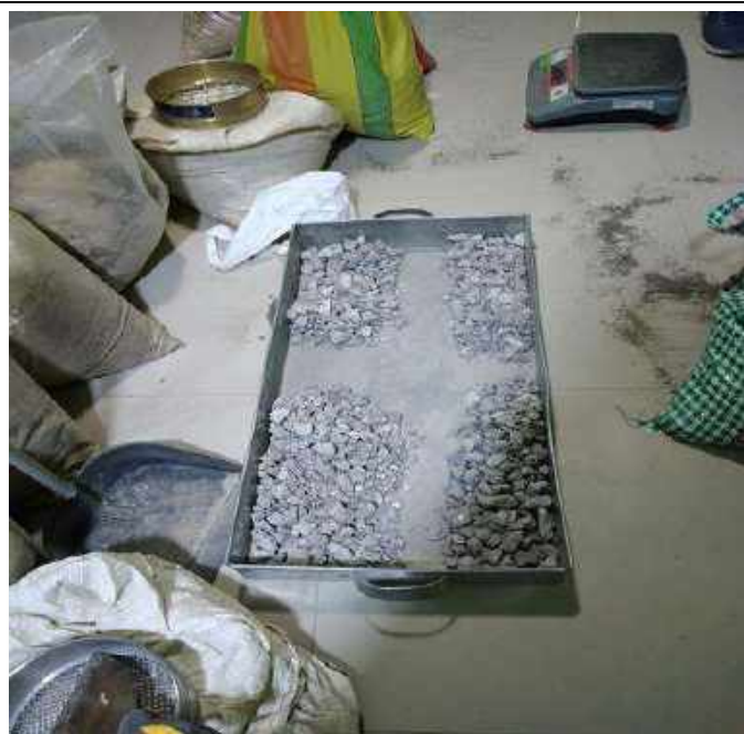
Cuarteo de la muestra y pesado de muestra representativa para el ensayo de contenido de humedad, del agregado grueso reciclado.
