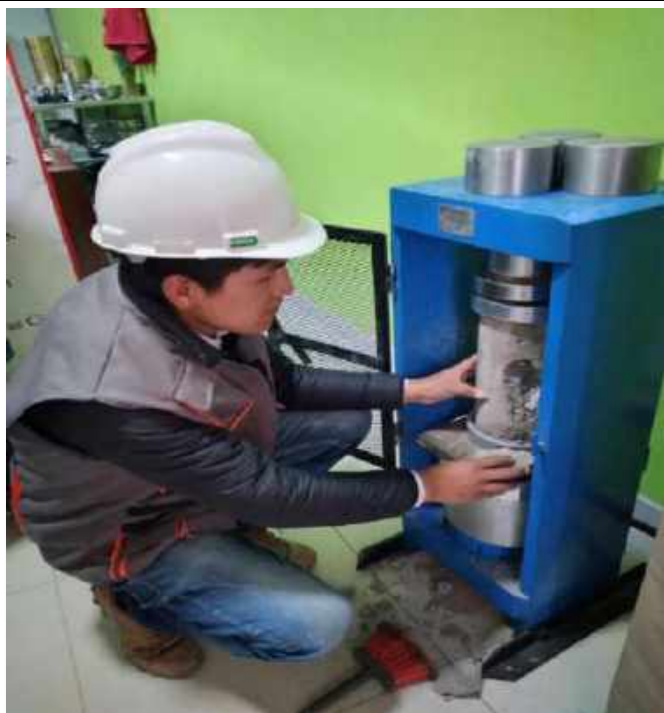
Ensayo a la compresión del concreto f^c=210 kg/cm 2 a las edades de 7, 14 y 28 días, muestra patrón y muestras experimentales.
