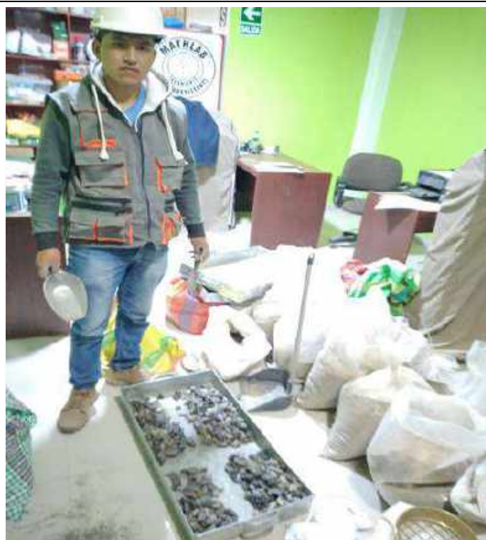
Cuarteo de la muestra y pesado de muestra representativa para el ensayo de contenido de humedad, del agregado grueso natural.
