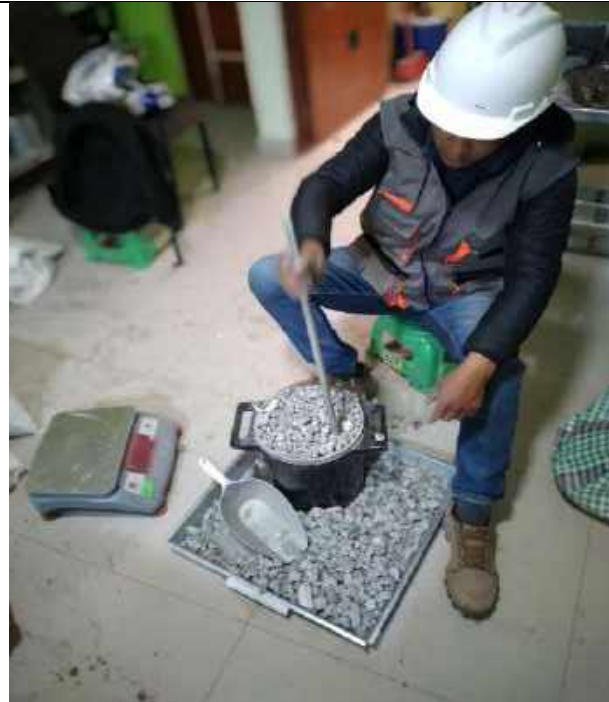
Ensayo de peso unitario suelto y peso unitario compactado del agregado grueso reciclado.
