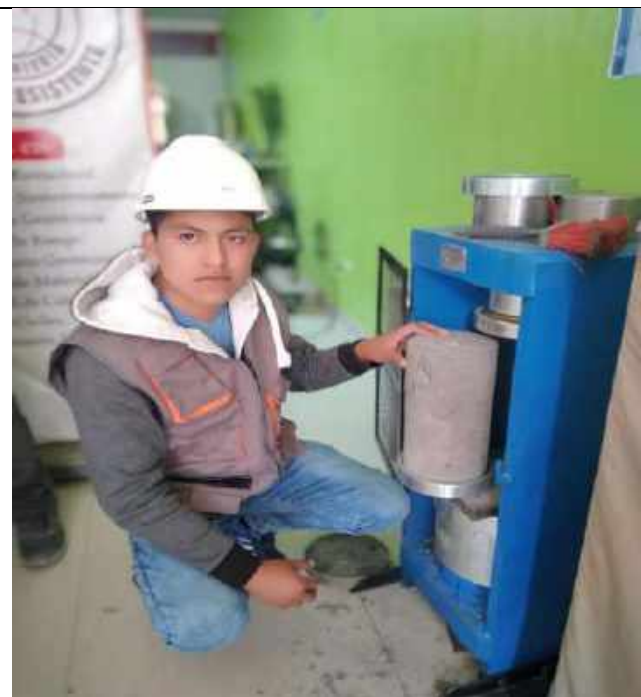
Ensayo a la compresión del concreto f^c=210 kg/cm 2 a las edades de 7, 14 y 28 días, muestra patrón y muestras experimentales.
