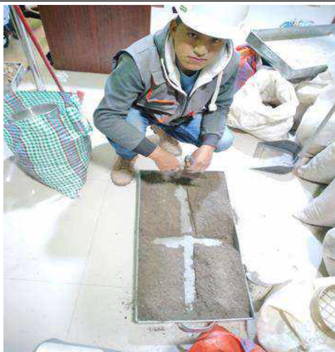
Cuarteo de la muestra y pesado de muestra representativa para el ensayo de contenido de humedad del agregado fino.
