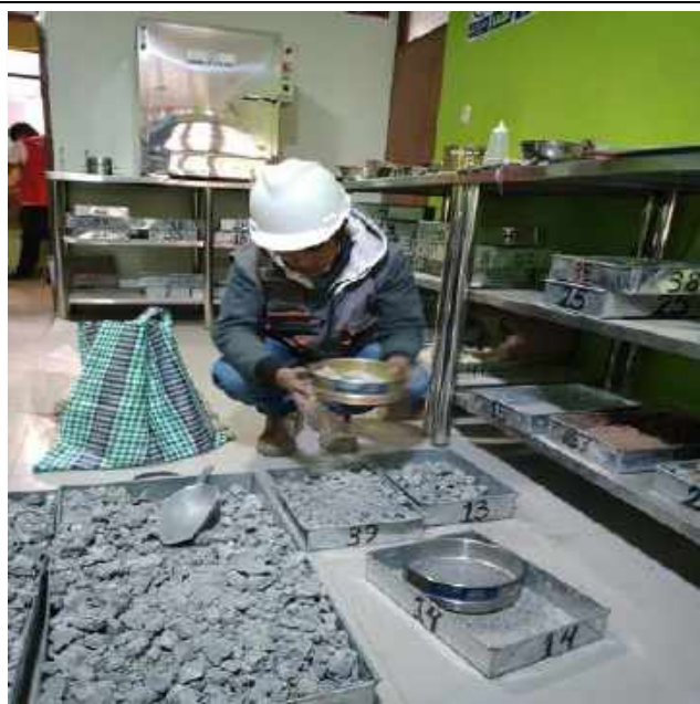
Tamizado de la muestra triturada por la malla 1" y eliminación de finos, obtención de muestra de agregado grueso reciclado.
