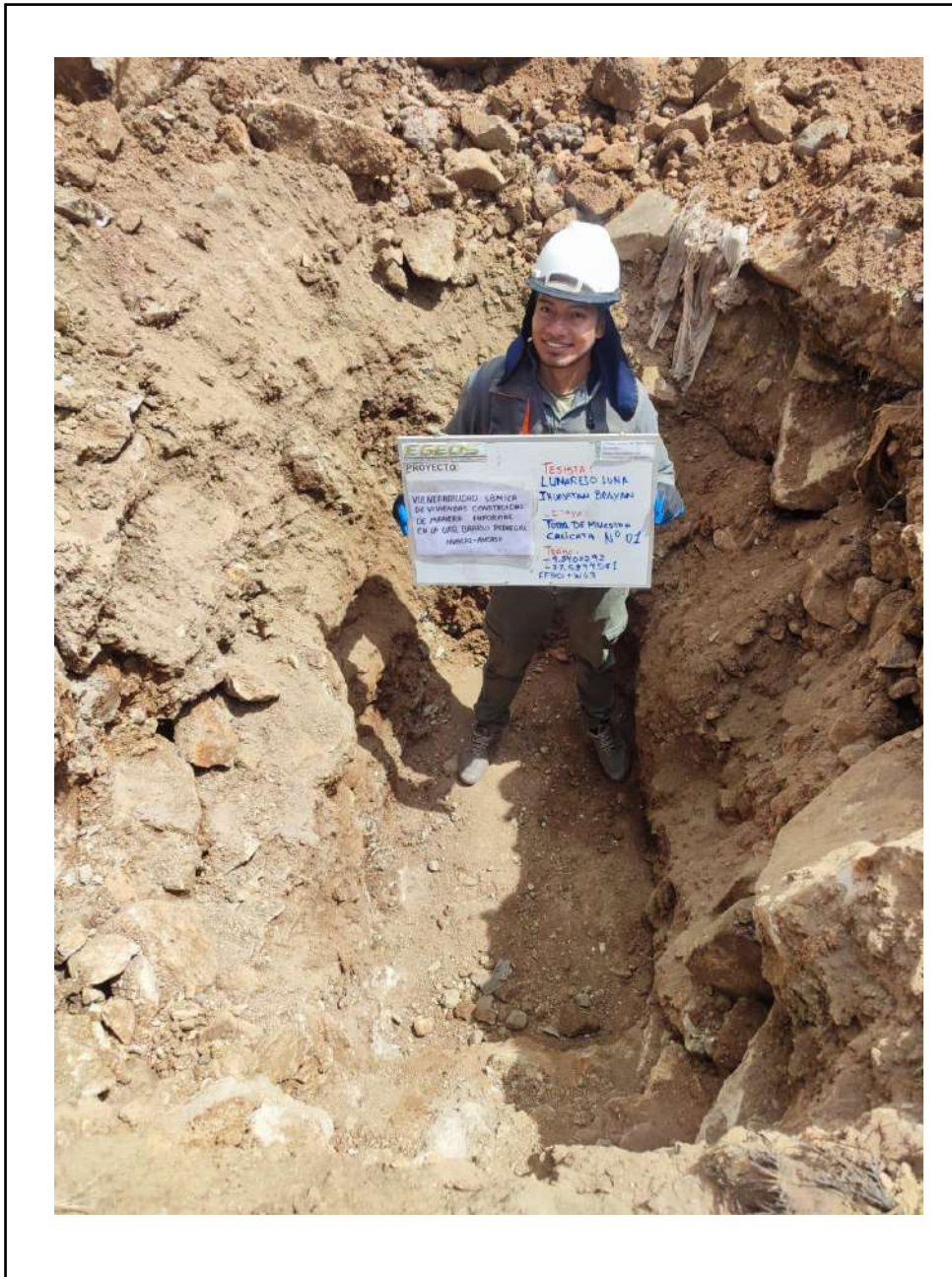
Figura 80. Fotografías del proceso de excavación de calicata.
