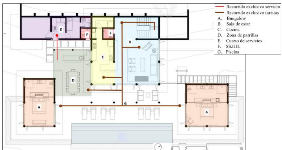
Figura 56. Planta segundo nivel de villa típica - Análisis funcional Fuente: Archdaily.com – Elaboración propia
