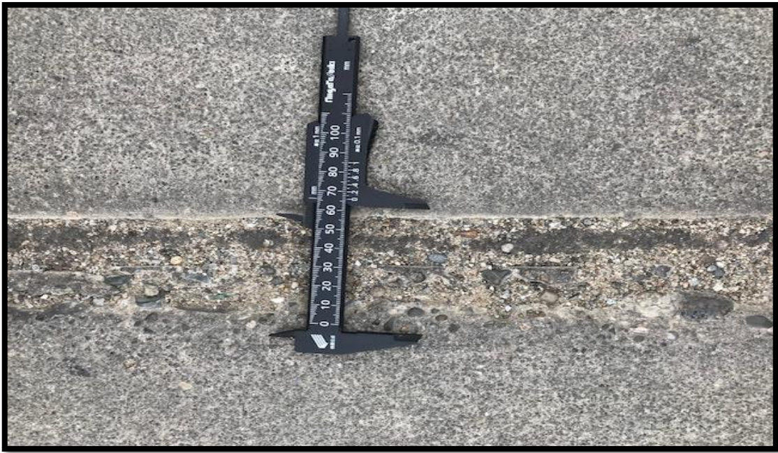
Figura 18: midiendo la junta con vernier
