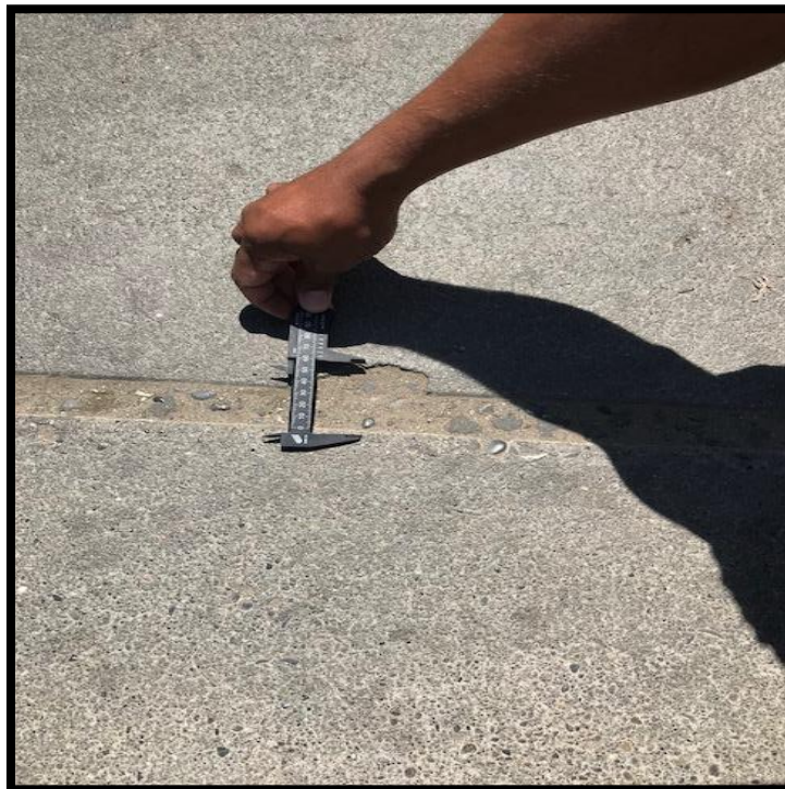
Figura 9: Midiendo la junta con vernier de pavimento
