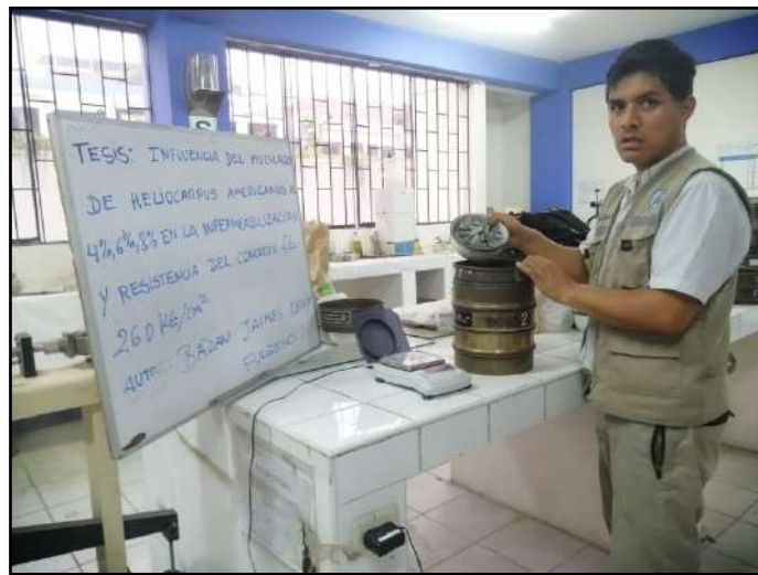
Foto 10 Tamizado para granulometría de agregado fino
