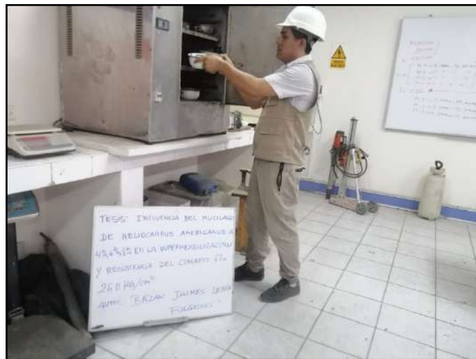
Foto 6 Secado para determinación de humedad de agregados, fino y grueso
