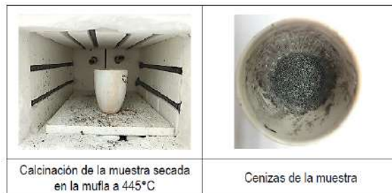
FIGURA N°2. CALCINACIÓN DE LA MUESTRA EN LA MUFLA (DAIHAN SCIENTIFIC) A 445°C.
