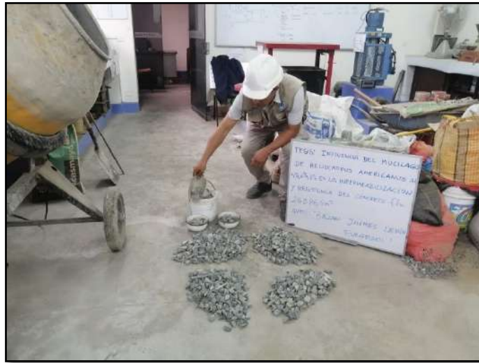
Foto 7 Cuarteo de agregado grueso
