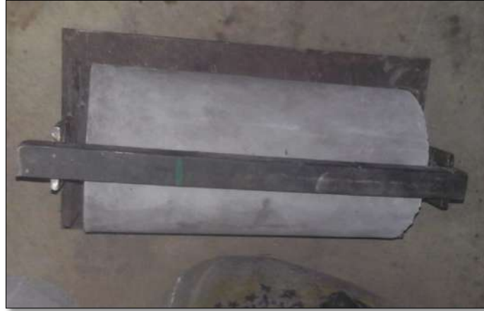
Foto 21 Alineamiento de probeta en el aparato de sostenimiento para ensayo de tracción indirecta para determinar profundidad de penetración del agua.
