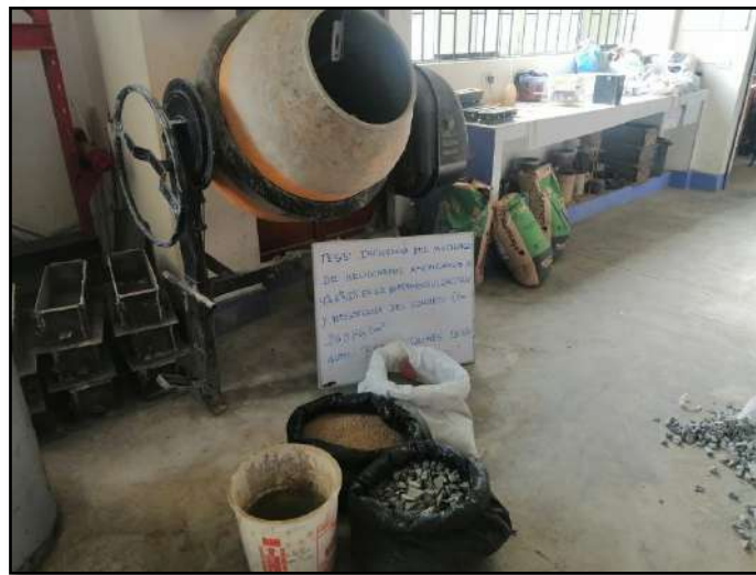
Foto 12 Materiales utilizados en la elaboración del concreto
