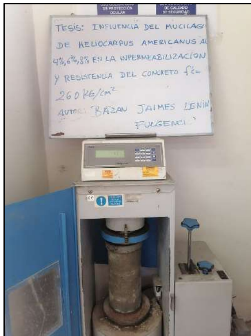
Foto 18 Ensayo de compresión del concreto patrón
