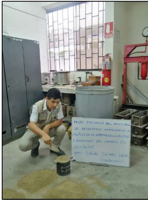
Foto 11 Determinación de peso unitario de agregado fino
