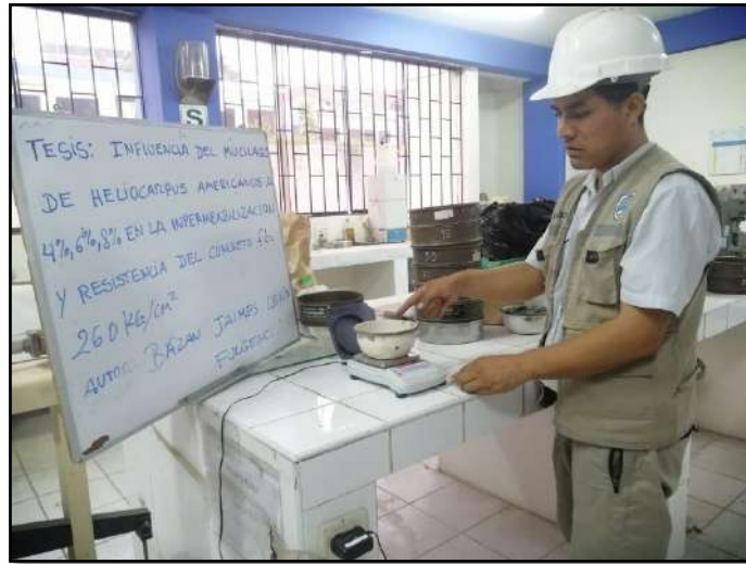
Foto 5 pesado para determinación de humedad de agregados fino
