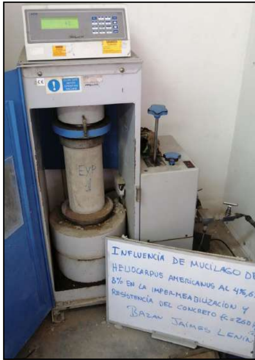
Foto 19 Ensayo de compresión del concreto experimental 1
