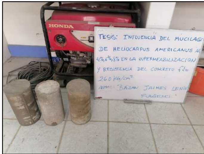
Foto 17 desmoldado de concreto patrón
