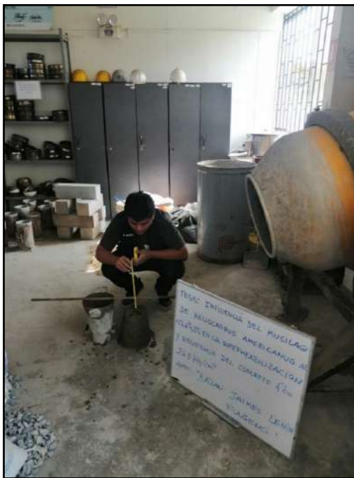
Foto 14 Medición para la determinación de la consistencia (cono de Abrams)
