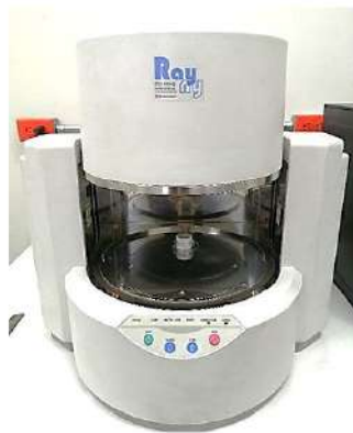
FIGURA N°3. ANÁLISIS DE COMPOSICIÓN QUÍMICA USANDO EL ESPECTRÓMETRO DE FLUORESCENCIA DE RAYOS X DE ENERGÍA DISPERSIVA (SHIMADZU, EDX-800HS).
