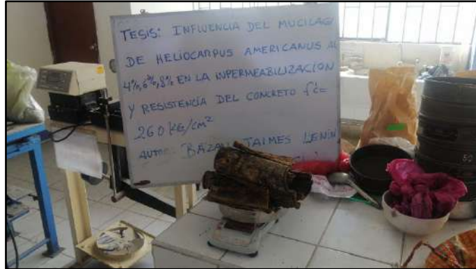
Foto 1 pesado de corteza de Heliocarpus americanus
