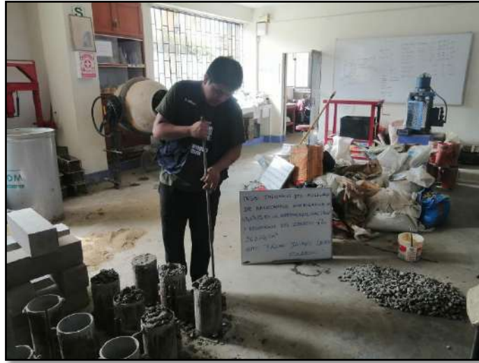
Foto 15 Varillado de probetas cilíndricas con 25 golpes por capa, tres capas
