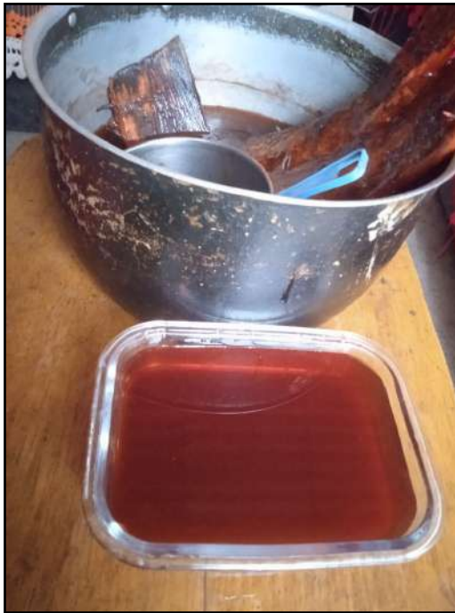
Foto 3 Obtención del mucilago del Heliocarpus americanus luego del hervido y enfriado
