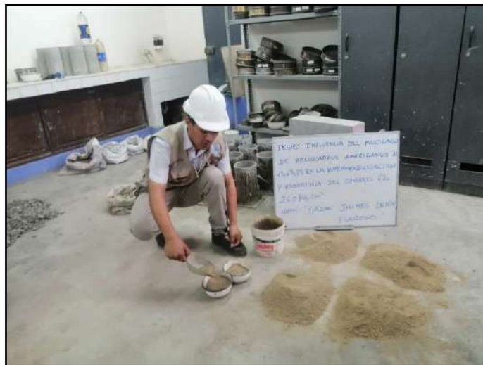
Foto 8 Cuarteo de agregado grueso
