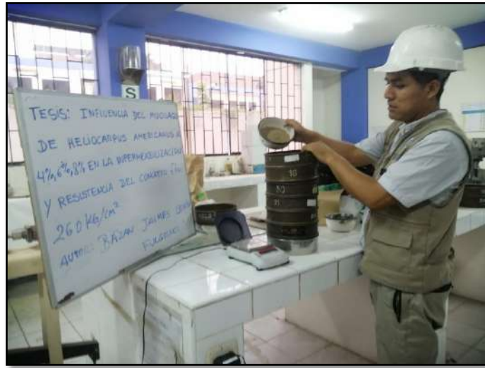
Foto 9 Tamizado para granulometría de agregado fino
