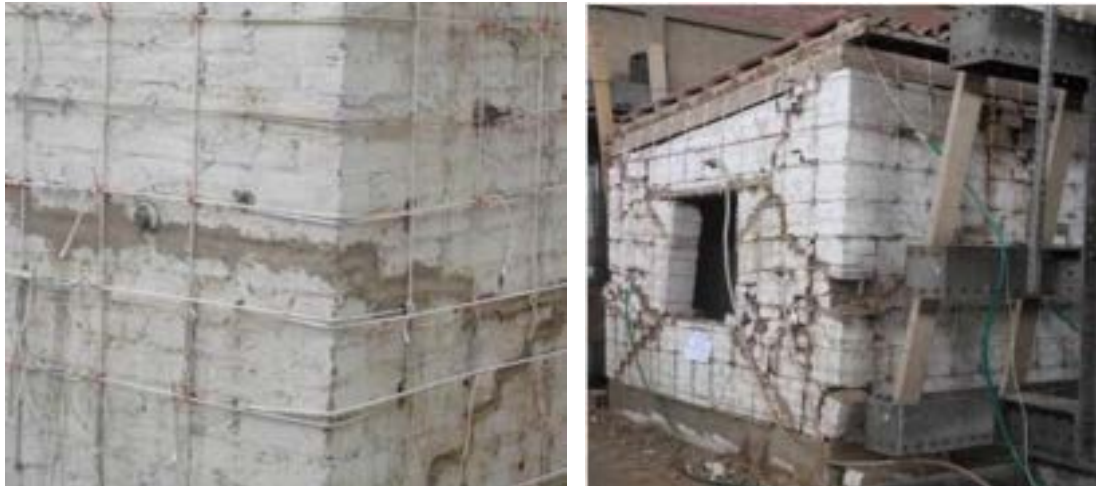
Figura 12. Refuerzo con malla de cuerda (Sosa y Soto, 2014)
