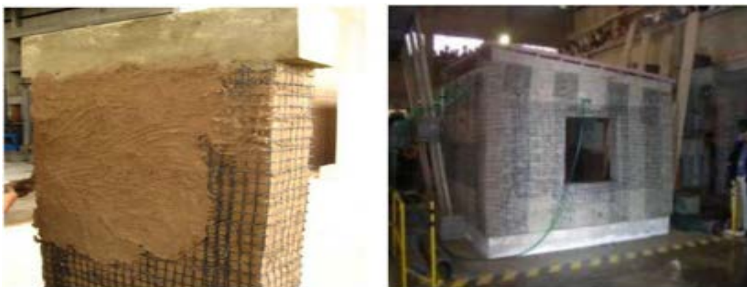
Figura 10 – Refuerzo con geomalla (Blondet et al., 2006; Solís et al., 2015)
