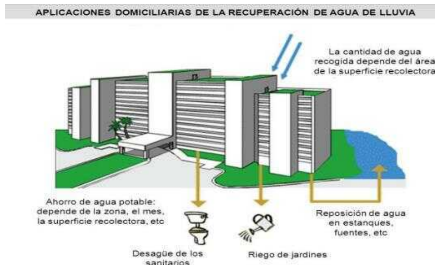
Figura 32: Sistema de captación de agua pluvial en techos Fuente: Collet Fecha: 2015
