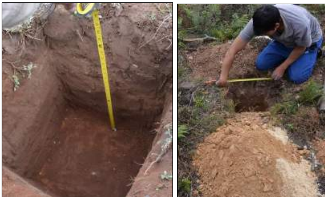
Fotografía 18. Calicata en la captación existente. Fuente y Elaboración: Propia.
