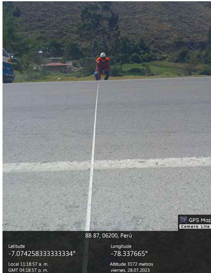
Foto N° 03 muestra medida del ancho del carril
