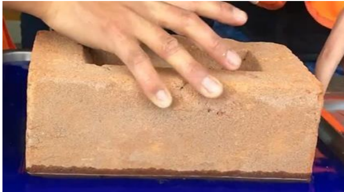
FIGURA # 31 Asentado de ladrillo para prueba de succión
