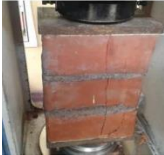
FIGURA 24 Ensayo en pilas.
