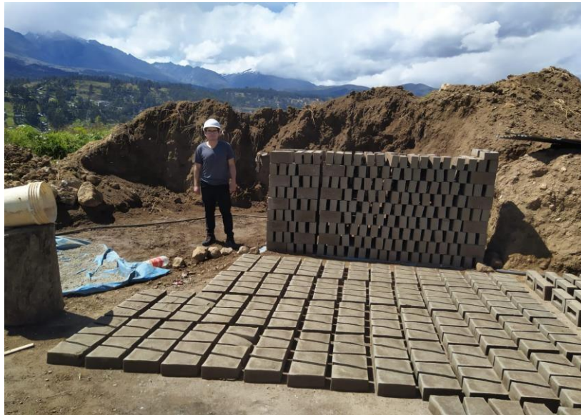
FIGURA # 13 Secado del ladrillo.
