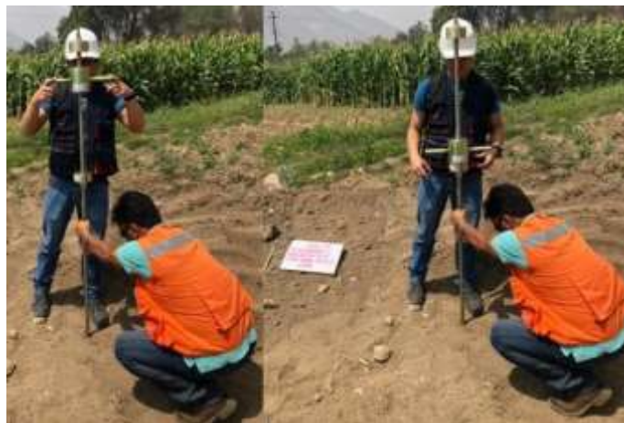
Figura 4. Aplicación del ensayo de DPL
