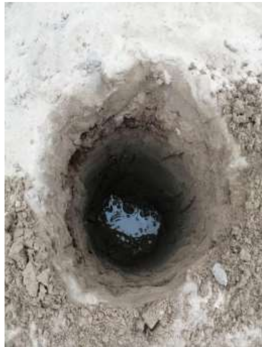
Foto 5 y 6: Calicatas realizadas en el suelo del P.J. Miramar Bajo
