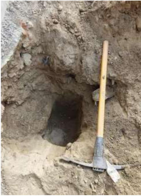
Foto 5 y 6: Calicatas realizadas en el suelo del P.J. Miramar Bajo
