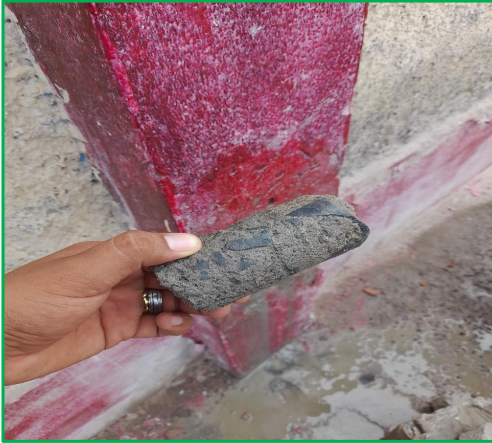
Muestra del testigo extraído para ser llevado a laboratorio
