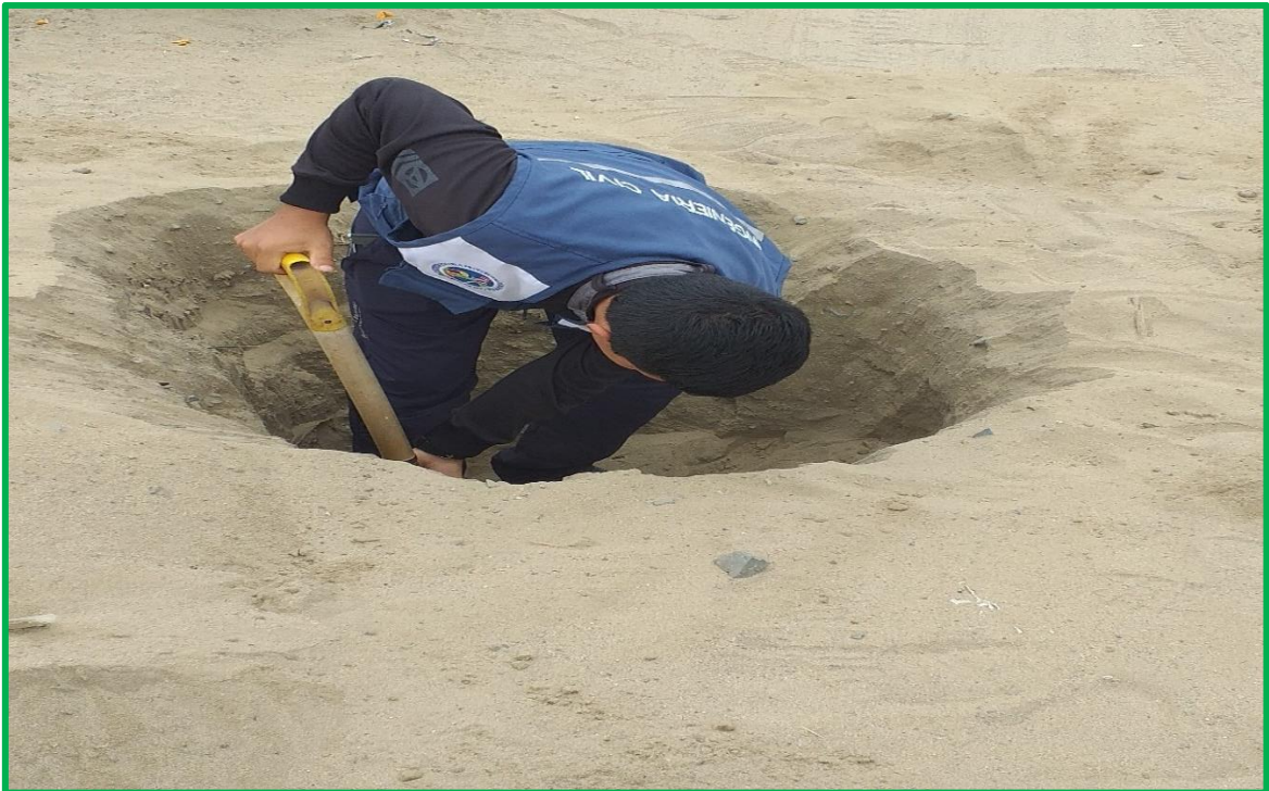
Excavación de calicata para el estudio correspondiente de suelos
