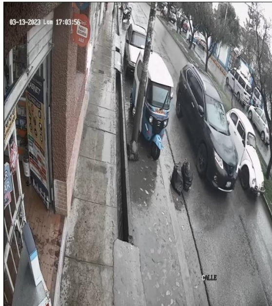
Fotografía 5 Video de cámara de seguridad utilizado como herramienta de recolección de datos (conteo vehicular en ambos sentidos) para hallar el IMDV, lunes 13/03/23.
