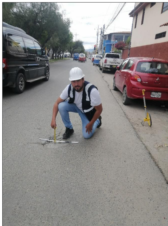
Fotografía 8 Medición de patología hueco, severidad media. Av. Mario Urteaga, sentido NO – SE.
