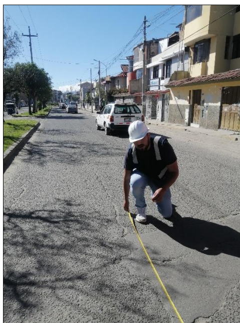
Fotografía 10 Medición de patología parcheo, severidad media. Av. Mario Urteaga, sentido NO – SE.
