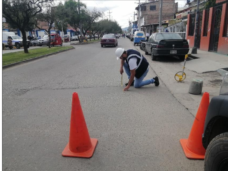
Fotografía 7 Medición de patología parcheo, severidad media. Av. Mario Urteaga, sentido NO – SE.
