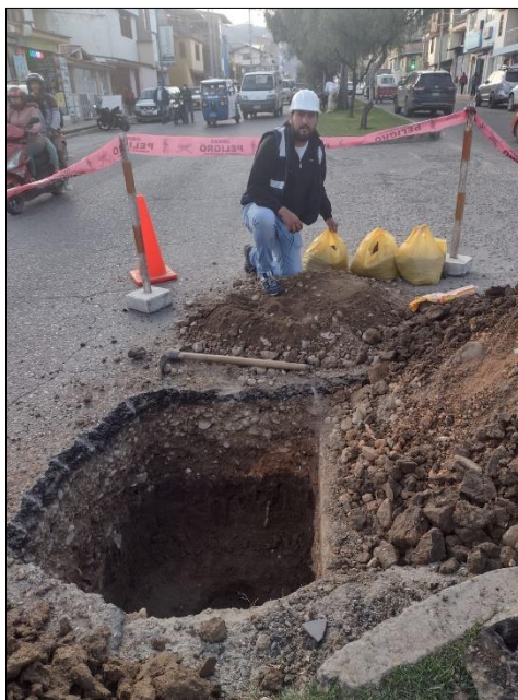
Fotografía 2 Recolección de muestras para ensayos de suelos en laboratorio C-2. Av. Mario Urteaga, sentido NO – SE.
