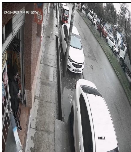
Fotografía 4 Video de cámara de seguridad utilizado como herramienta de recolección de datos (conteo vehicular en ambos sentidos) para hallar el IMDV, viernes 10/03/23.
