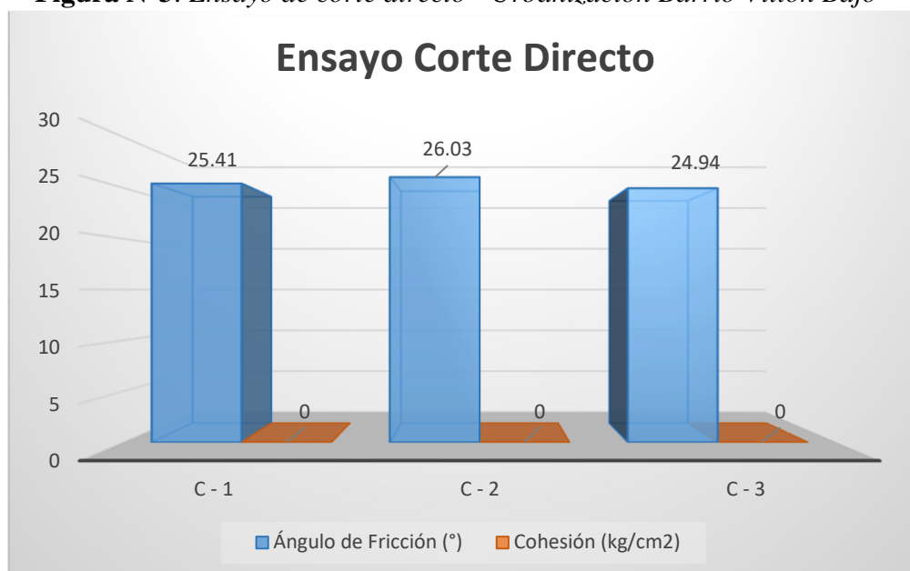
Figura N°3: Ensayo de corte directo - Urbanización Barrio Villon Bajo
