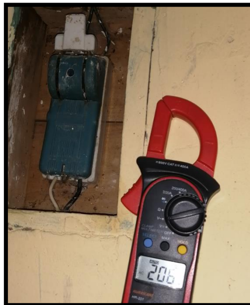
Figura 7: Medición de tensión con pinza amperimétrica
