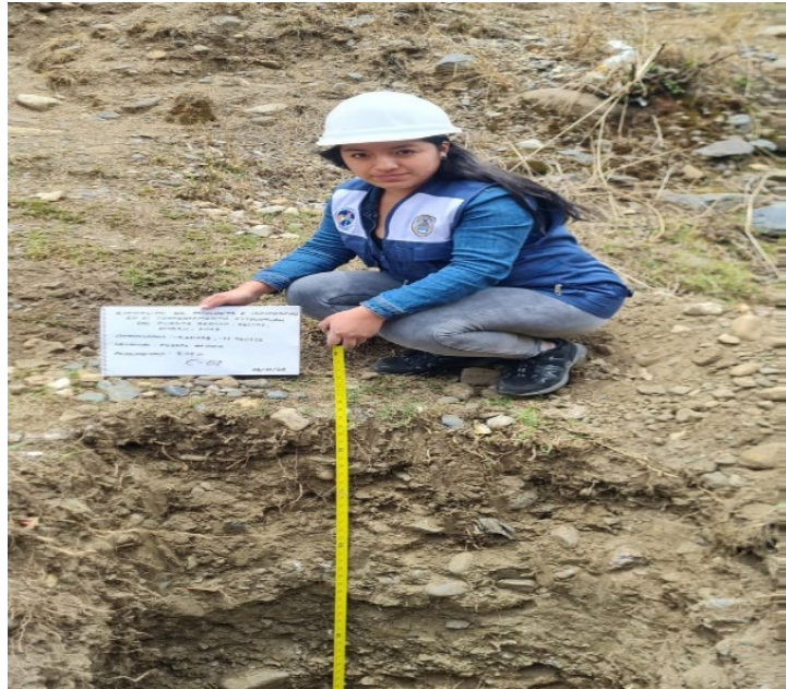
Fotografía 03: Se observa el registro de la calicata
