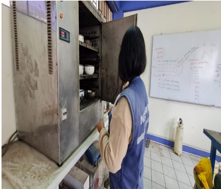
Fotografía 05: Se observa la muestra colocada en el horno de secado.
