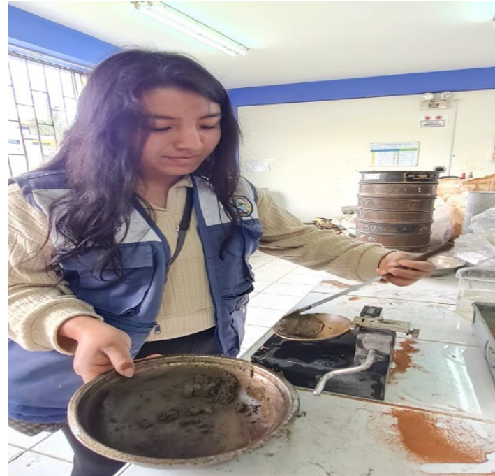
Fotografía 08: Se observa, la muestra colocada en la copa CASAGRANDE.
