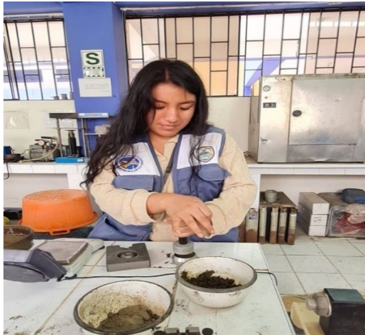
Fotografía 07: Se observa la compactación de la muestra.
