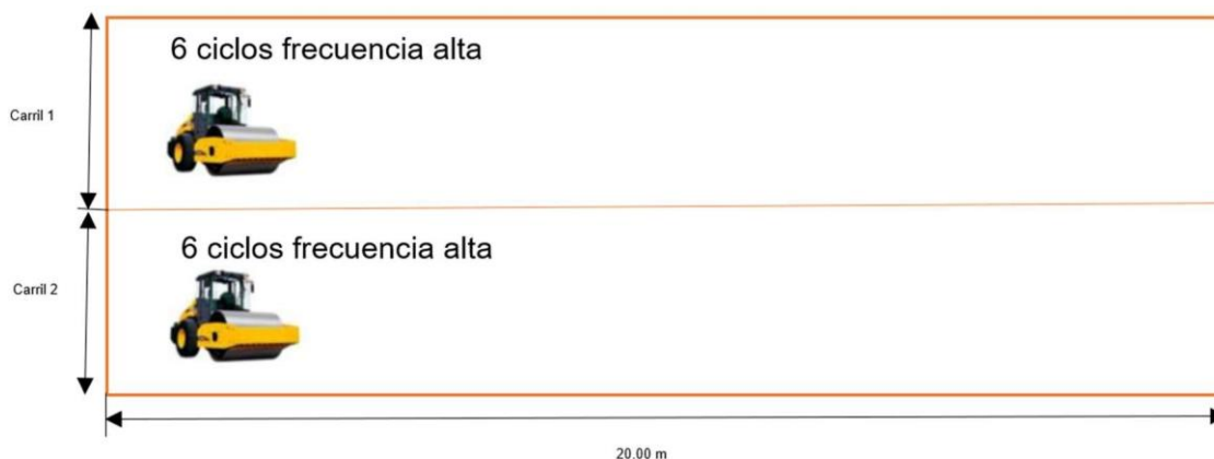
Figura N° 04: Detalle Proceso de Compactación en cada carril ejecutado, en el Panel Test de 30 cm.
