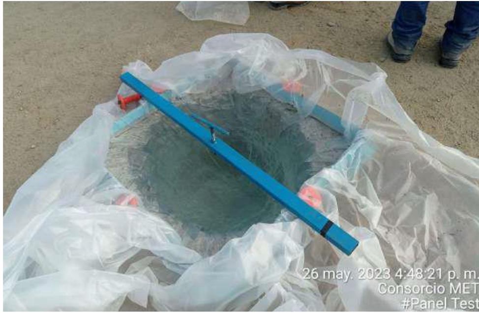
Ensayo de control de compactación con método de remplazo de agua.
