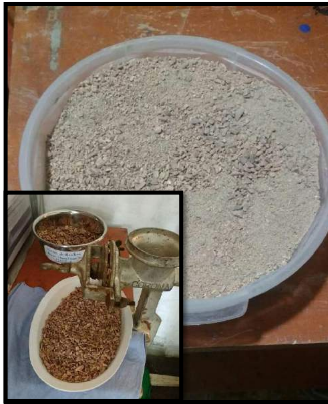
Figura N°56 Comparación de pesos antes y después de la mufla para así poder sacar el porcentaje de humedad
