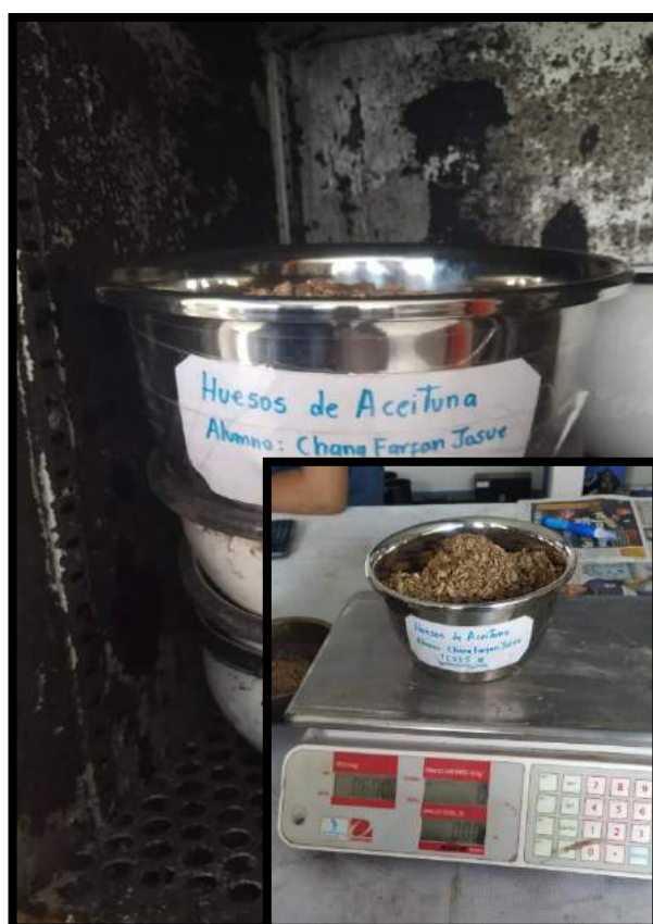
Figura N°54 Se dejó nuestra muestra de huesos de aceitunas en la mufla a 100°C por 4 horas
