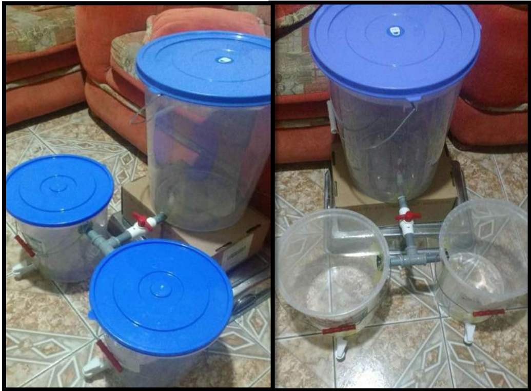
Figura N°64 Armado del Biofiltro casero con los materiales descritos
