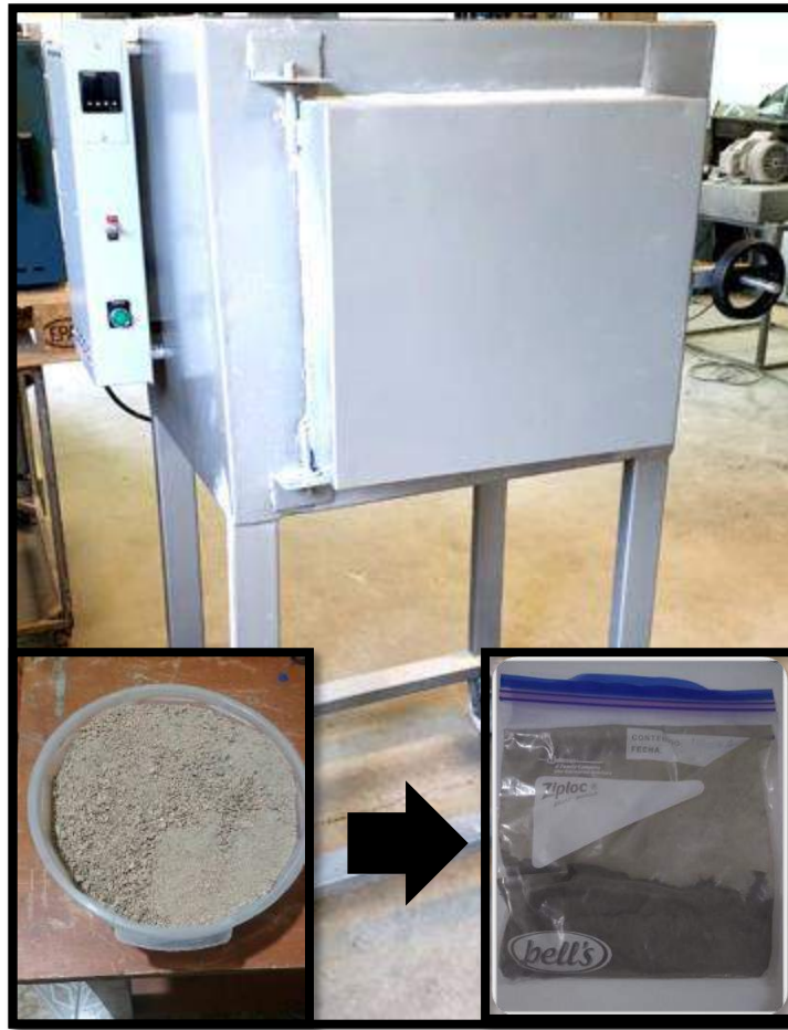
Figura N°58 Después de haber pasado la malla #200 y realizado el ensayo de ATD Se llevó nuestra muestra a la mufla del laboratorio de suelos a 380°C.
