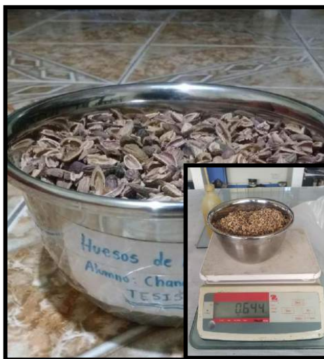
Figura N°53 Se pesó los huesos de aceitunas para sacar nuestro porcentaje de humedad en la mufla en el laboratorio de suelos
