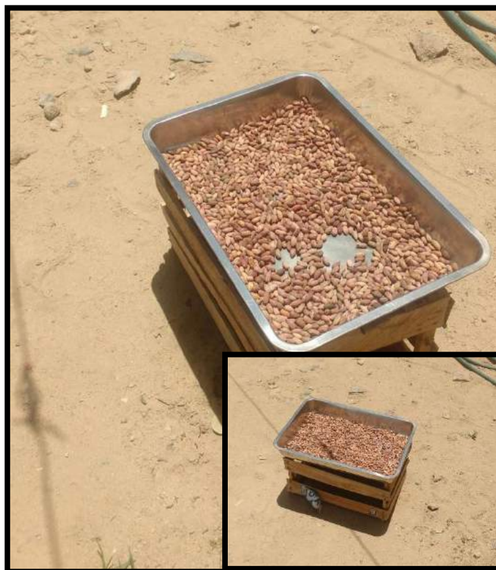
Figura N°51 Se dejó secar la muestra de pepas de aceitunas durante 3 días a temperatura ambiente de (22-24°C).
