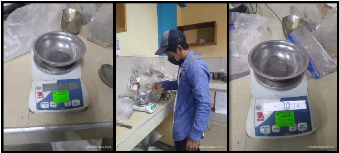
Figura N°60 Separación de muestras según sus dosis empleados para los ensayos requerido, se observa dosis de 6.0g/L y 7.0g/L
