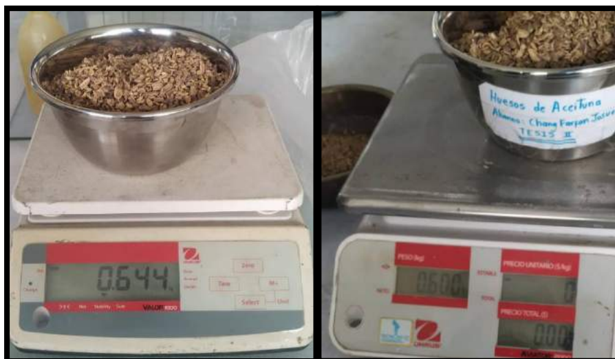
Figura N°55 Comparación de pesos antes y después de la mufla para así poder sacar el porcentaje de humedad de nuestra muestra de huesos de aceitunas.
