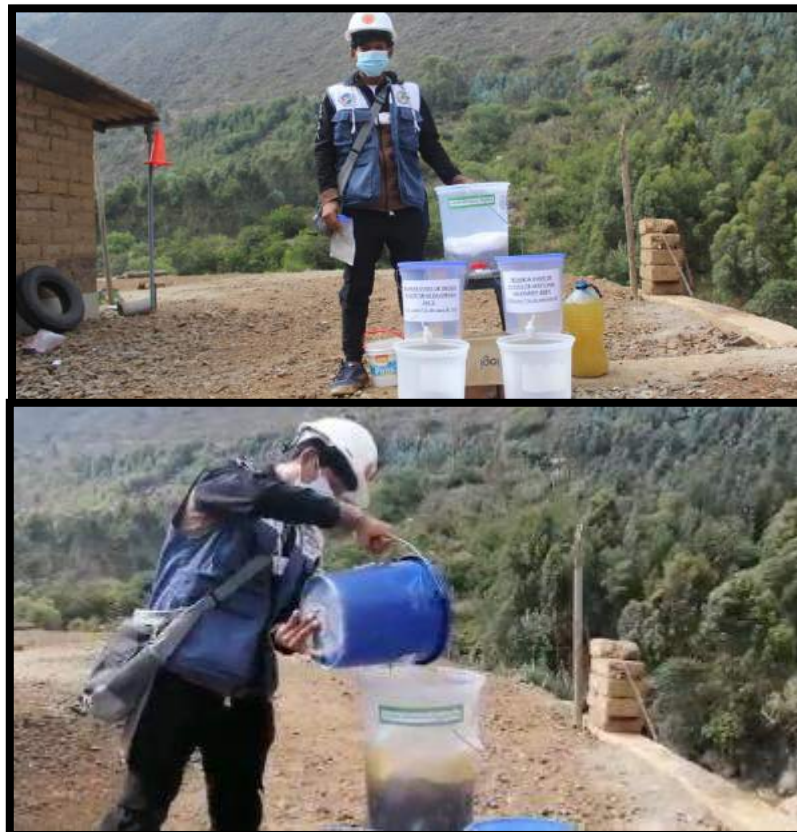
Figura N°67 Llenando el Balde Primario de 20L con el agua del rio Moche- Casmiche
