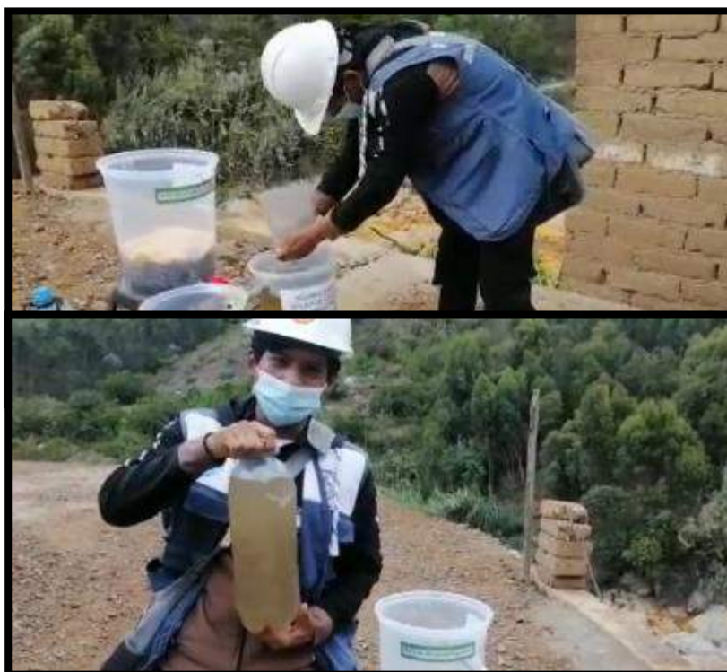
Figura N°69 Después de echar las dosis batiremos lentamente el agua por unos 20 min y esperemos 40 min reposar para apreciar su remoción de los metales pesados.
