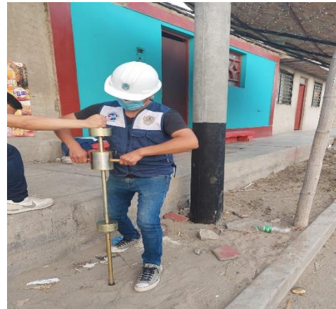
FOTO N°6: Se procedió a llevar a cabo el ensayo de DPL en las casas con la asistencia del técnico del laboratorio AGAMES E.I.R.L
