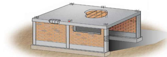
Figura 5. Albañilería Confinada (Aceros Arequipa, 2022)
