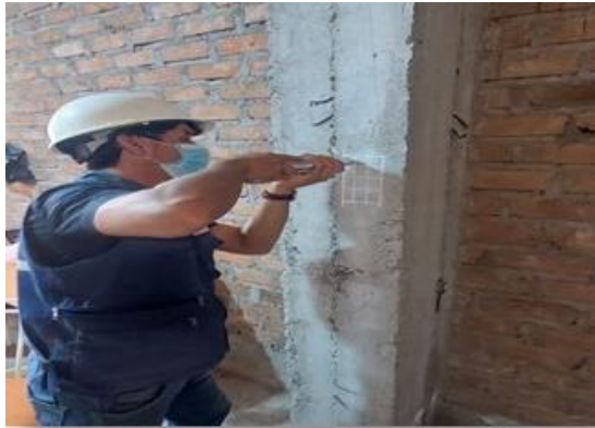
Figura 45. Esclerometría Jr. Fátima Mz.S2 Lt.4ª
