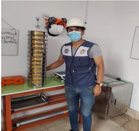
FOTO N°3: Tamices seleccionados para el ensayo de análisis granulométrico
