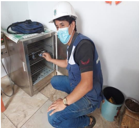
FOTO N°5: Colocación de las tres muestras naturales al horno para su previo secado.
