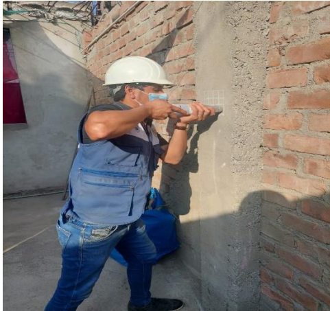
FOTO N°7: Aplicación de la esclerometría en la columnas y viga de la casa ubicado en Jr. Fátima Mz I2 – Lt 27
