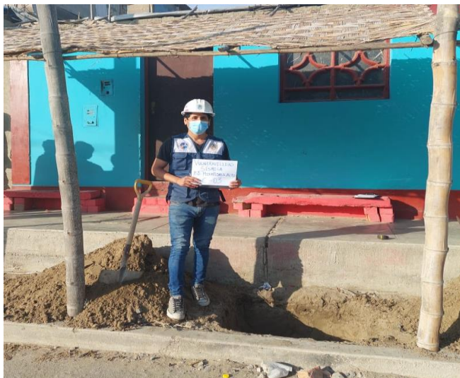
FOTO N° 2: Calicata realizada en vivienda localizada en Jr. Leoncio Prado Mz D2 – Lt 12
