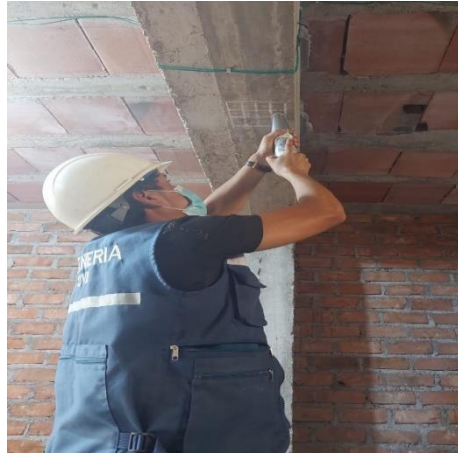
FOTO N°7: Aplicación de la esclerometría en la columnas y viga de la casa ubicado en Jr. Fátima Mz I2 – Lt 27
