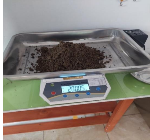
FOTO N°4: Realizando la determinación del peso del suelo obtenido durante el análisis granulométrico.
