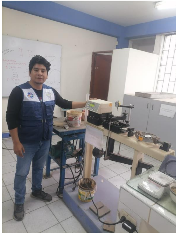
Figura 117. Prueba de Corte Directo.
