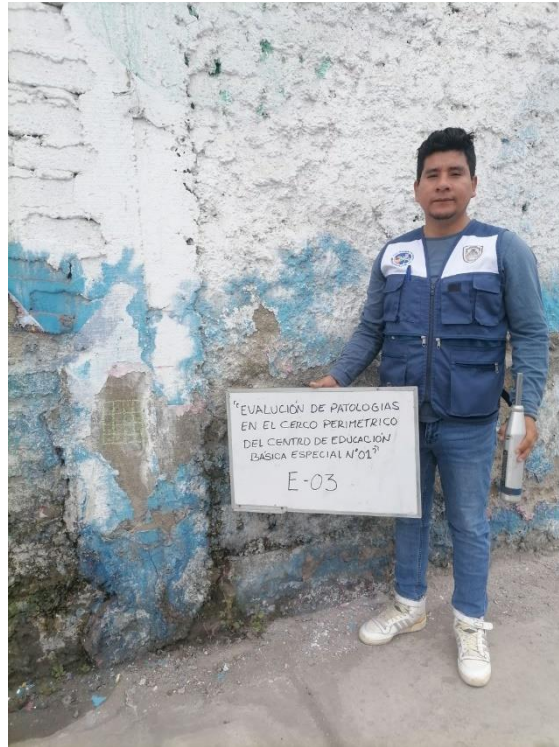
Figura 92. Trazado de la cuadrícula de 4 x 4 para el ensayo de esclerometría, columna E-03 – frente 3.
