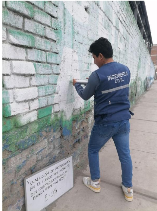
Figura 94. Muestra de la columna E-05 – tramo 3, para el ensayo de esclerometría.
