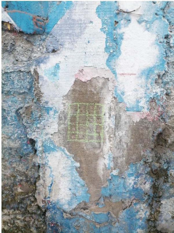
Figura 98. Trazado de la cuadrícula de 4 x 4 para el ensayo de esclerometría, columna E-06 – frente 3.
