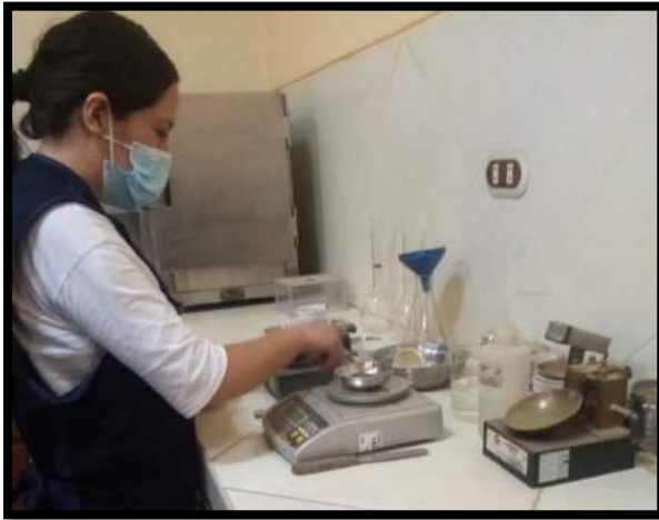
Anexo 20 y 21: Pesado de la muestra del límite líquido a: 11, 17, 27, 37 golpes.
