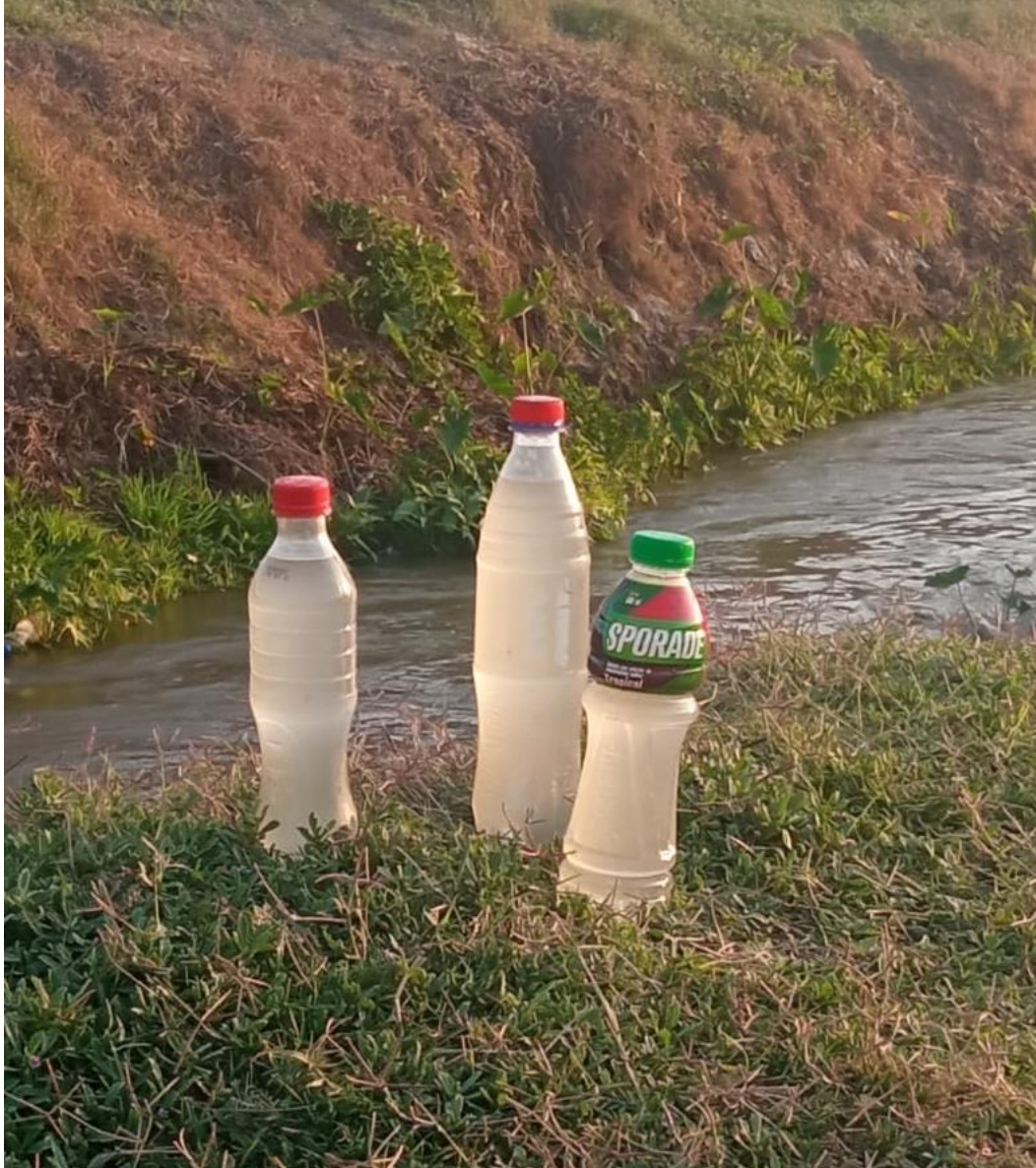
Figura 47. 1 ½ litros de muestra distribuida en 3 envases de plástico para su análisis correspondiente
