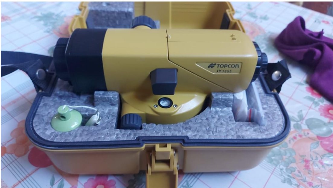
Figura 42. El levantamiento topográfico se realizó con nivel TOPCON JV1855
