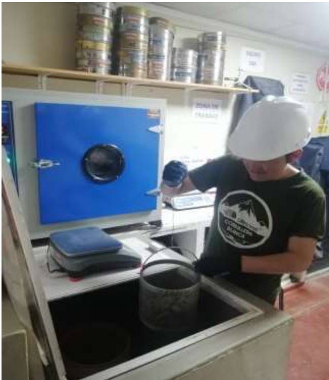
Foto N°18: Ensayo de peso específico del agregado grueso.
