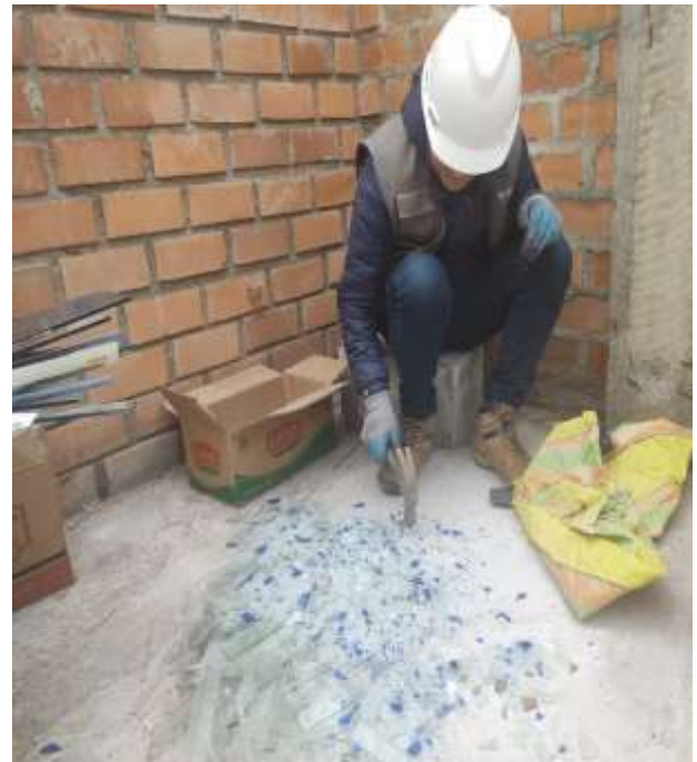
Foto N°04: Trituración de vidrio reciclado hasta obtener una muestra representativa como agregado fino.
