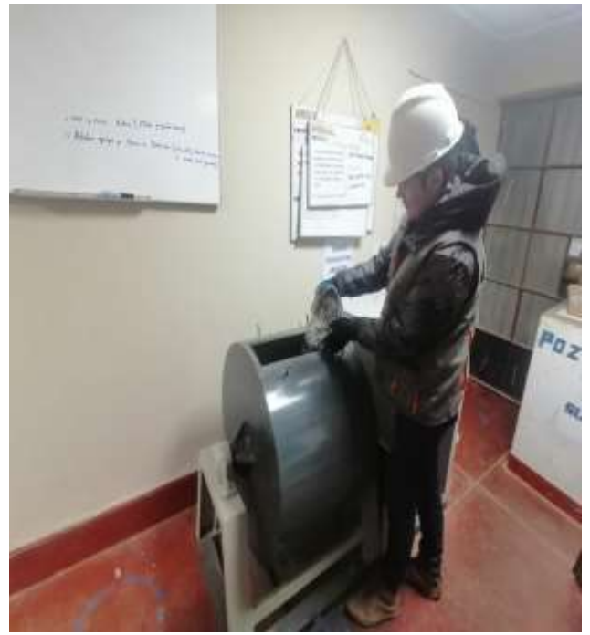
Foto N°14: Ensayo de desgaste a la abrasión con máquina de los ángeles del agregado grueso.
