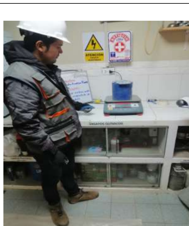
Foto N°17: Ensayo de peso unitario suelto y peso unitario compactado del agregado fino (vidrio molido).
