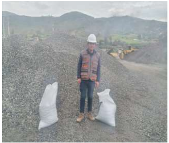
Foto N°02: Toma de muestra representativa del agregado grueso de \frac{3}{4} " de la cantera PATI-CARHUAZ.
