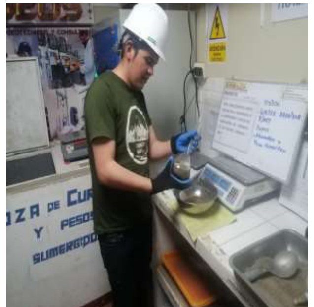
Foto N°19: Ensayo de peso específico del agregado fino (arena gruesa).
