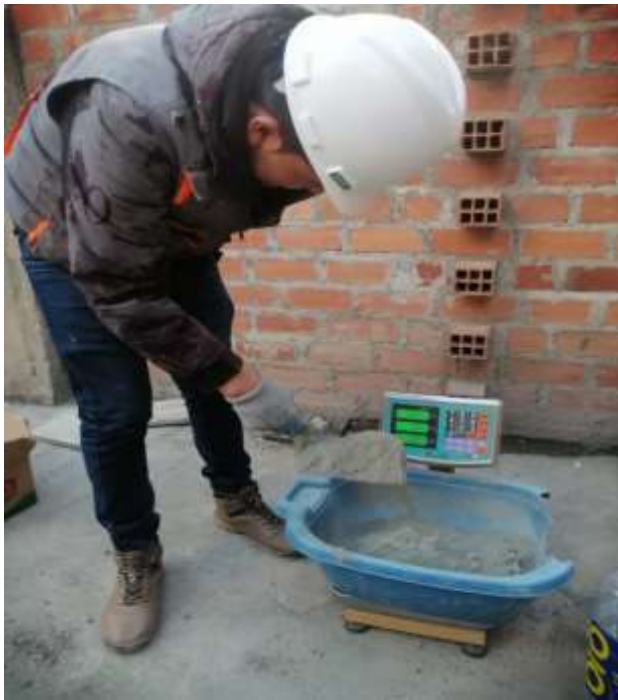
Foto N°22: Dosificación de materiales para la confección de probetas de diseño patrón y experimentales.
