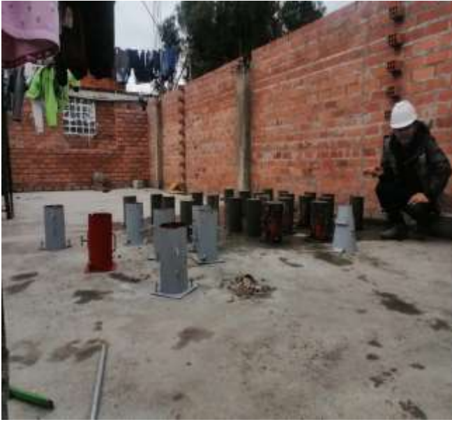
Foto N°26: Desencofrado de moldes de probetas y curado con agua potable por los 28 días.
