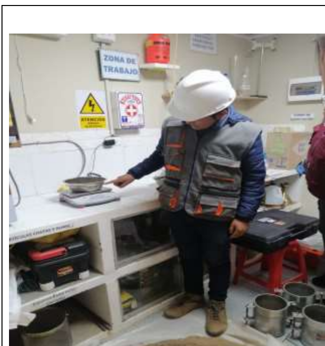
Foto N°07: Peso de muestra representativa del agregado fino para el ensayo de contenido de humedad.
