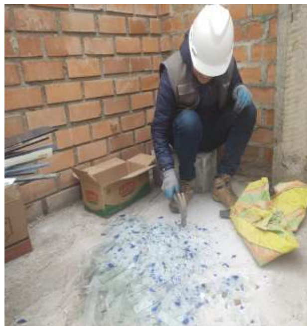
Foto N°06: Trituración de vidrio reciclado hasta obtener una muestra representativa como agregado fino.
