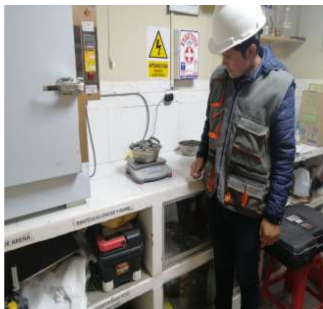
Foto N°08: Peso de muestra representativa del agregado grueso para el ensayo del contenido de humedad.
