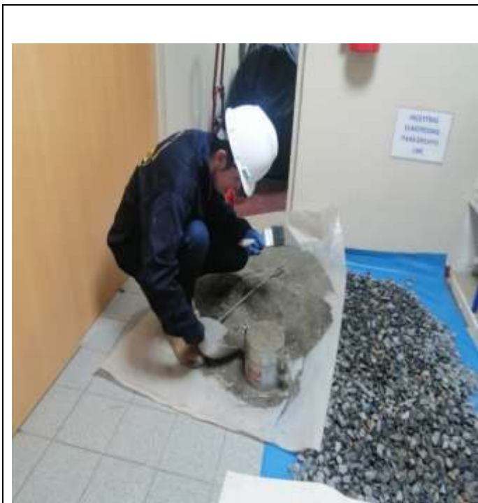
Foto N°16: Ensayo de peso unitario suelto y peso unitario compactado del agregado fino (arena gruesa).
