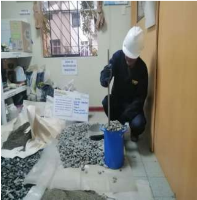
Foto N°15: Ensayo de peso unitario suelto y peso unitario compactado del agregado grueso (piedra chancada de ¾”).
