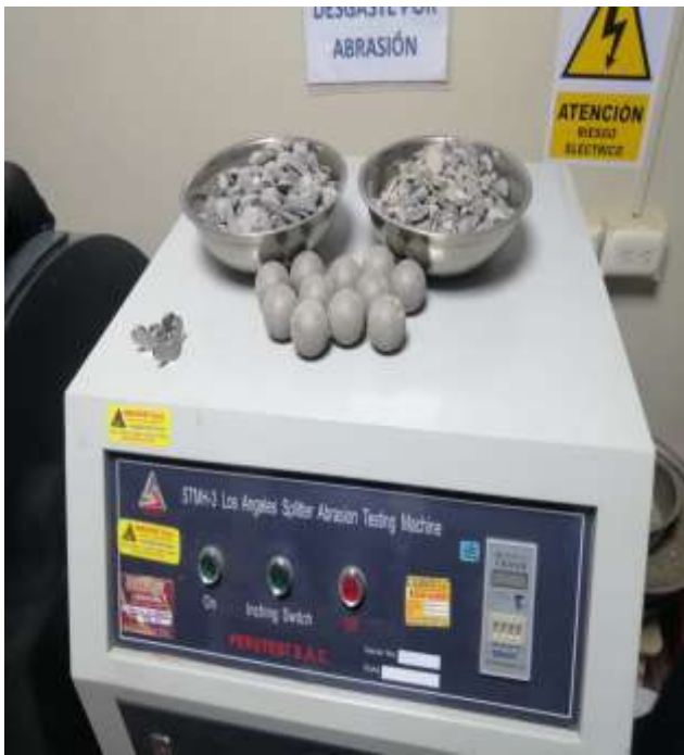
Foto N°13: Ensayo abrasión de los ángeles con gradación “B”.
