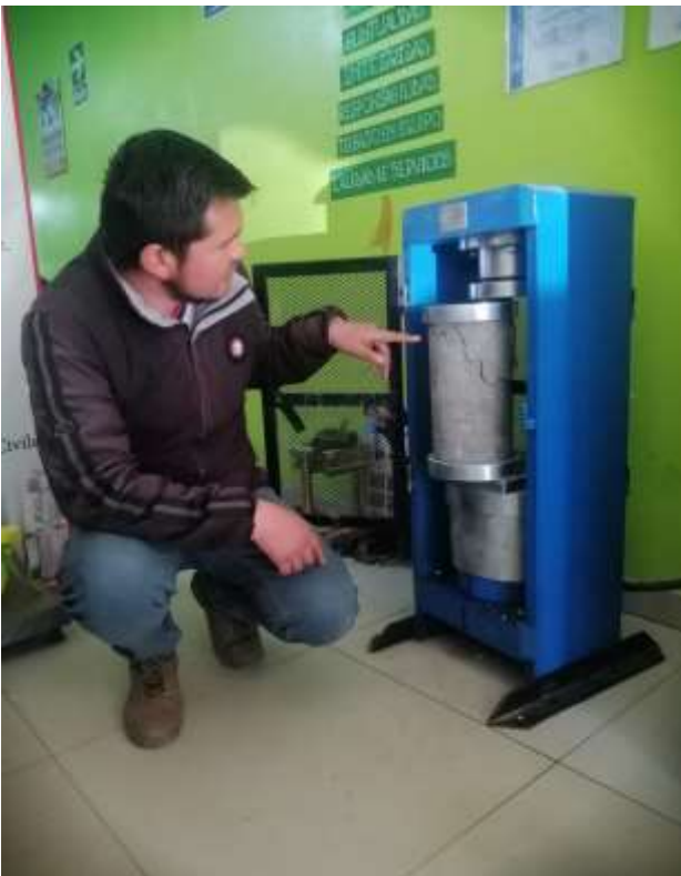
Foto N°27: Ensayo de resistencia a la compresión a las edades de 7, 14 y 28 días del diseño patrón y diseños experimentales
