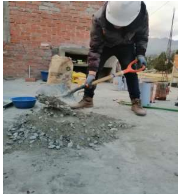
Foto N°23: Mezclado de concreto para la confección de probetas de concreto.
