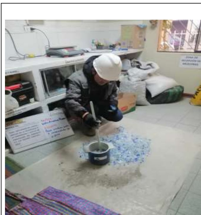
Foto N°17: Ensayo de peso unitario suelto y peso unitario compactado del agregado fino (vidrio molido).
