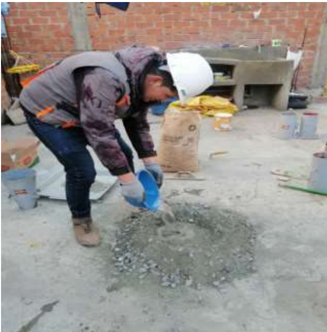
Foto N°23: Mezclado de concreto para la confección de probetas de concreto.
