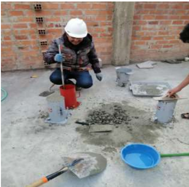
Foto N°25: Confección de probetas de diseño patrón y experimental.
