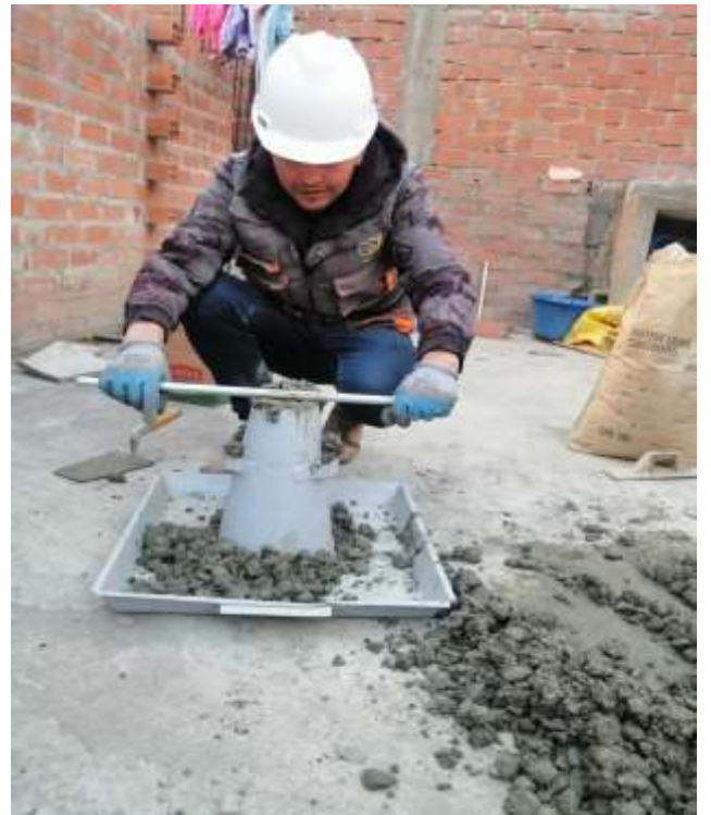
Foto N°24: Ensayo de asentamiento del concreto en estado fresco de la muestra patrón y experimental.
