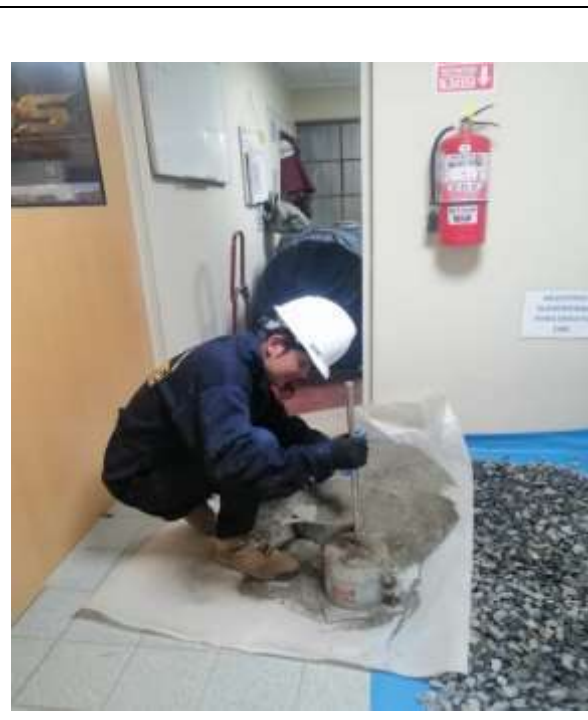
Foto N°16: Ensayo de peso unitario suelto y peso unitario compactado del agregado fino (arena gruesa).
