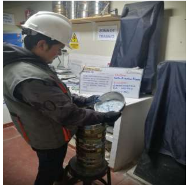
Foto N°12: Ensayo de análisis granulométrico del agregado fino (vidrio molido).
