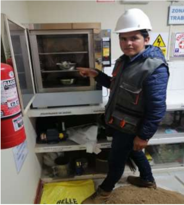
Foto N°09: Secado en el horno de los agregados para determinar el porcentaje de humedad.
