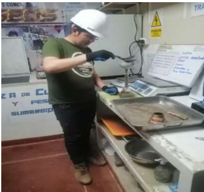
Foto N°19: Ensayo de peso específico del agregado fino (arena gruesa).
