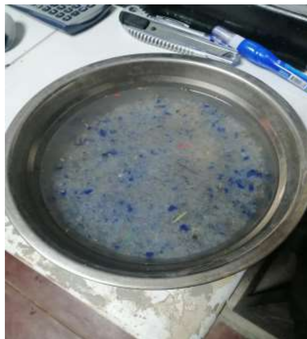
Foto N°21: Ensayo de peso específico y absorción del agregado fino (vidrio molido).
