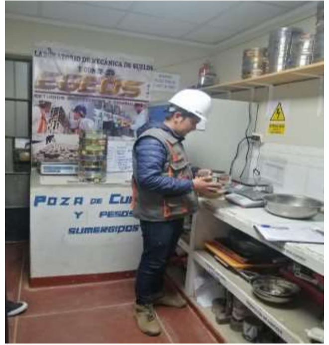
Foto N°10: Ensayo de análisis granulométrico del agregado grueso (piedra chancada).
