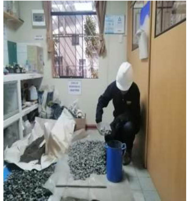
Foto N°15: Ensayo de peso unitario suelto y peso unitario compactado del agregado grueso (piedra chancada de ¾”).
