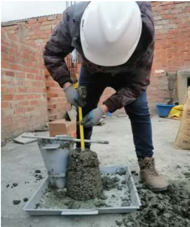
Foto N°24: Ensayo de asentamiento del concreto en estado fresco de la muestra patrón y experimental.
