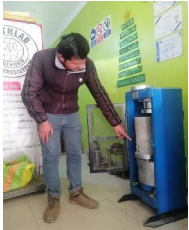
Foto N°27: Ensayo de resistencia a la compresión a las edades de 7, 14 y 28 días del diseño patrón y diseños experimentales
