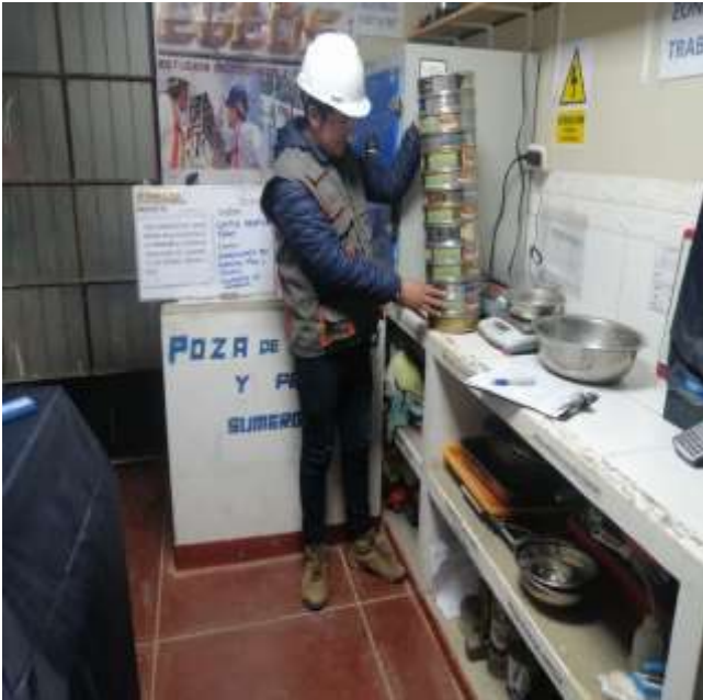
Foto N°11: Ensayo de análisis granulométrico del agregado fino (arena gruesa).
