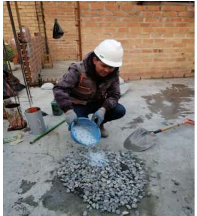
Foto N°22: Dosificación de materiales para la confección de probetas de diseño patrón y experimentales.
