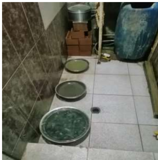
Foto N°20: Ensayo de absorción de los agregados finos y grueso (piedra chancada y arena gruesa).
