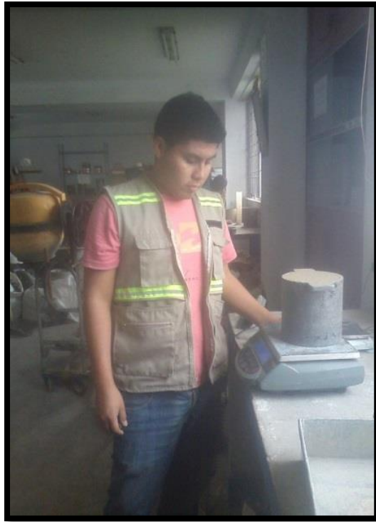
Figura 14: Estudio de peso unitario de agregado fino
