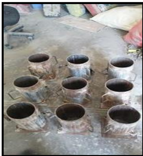
Figura 20: Probetas listas, para darse el vaciado de concreto
