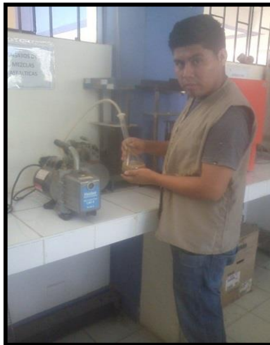
Figura 15: Estudio de gravedad especifica de agregado fino
