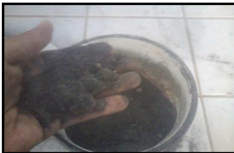
Figura 18: Desperdicio de CPA después de ser pasada por malla 100
