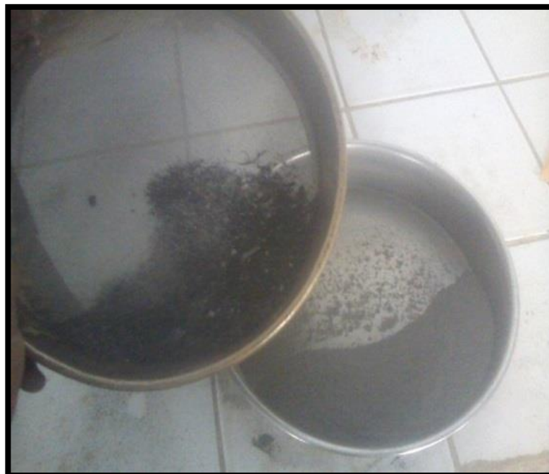
Figura 17: CPA pasada por malla 100 para luego ser calcinada
