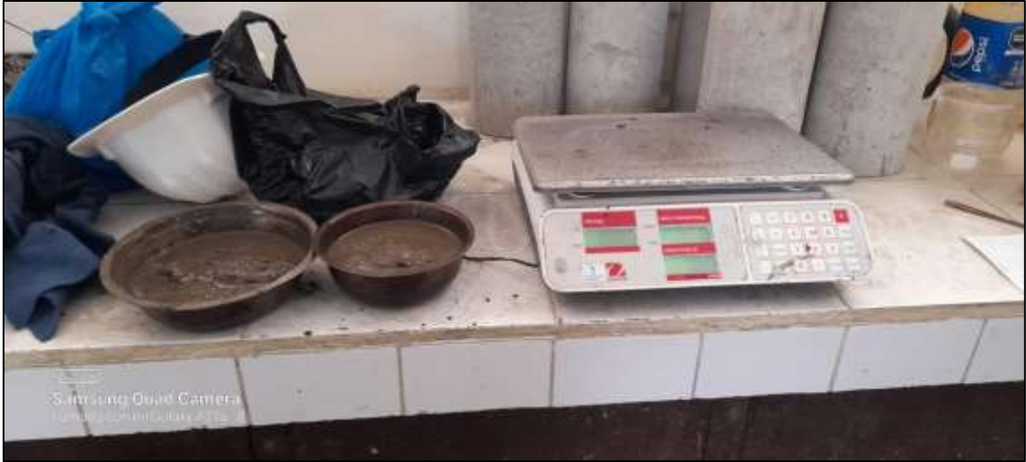
Las muestras extraídas en campo se pesaron en taras.
