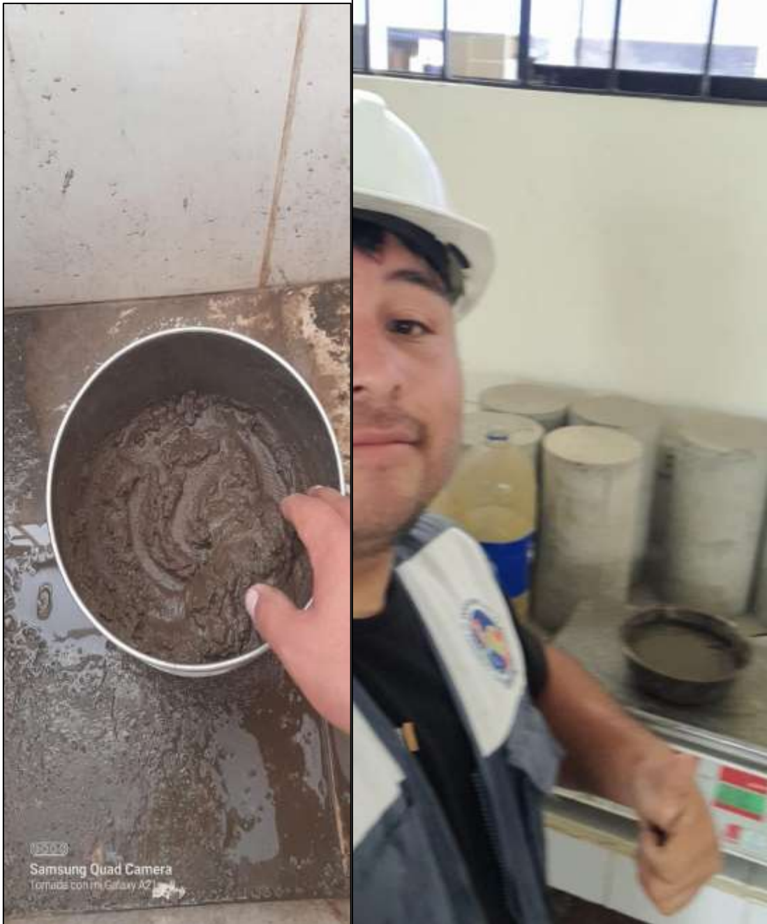
Una vez lavada bien la muestra y pasado por la maya, volvemos a pesarlo.
