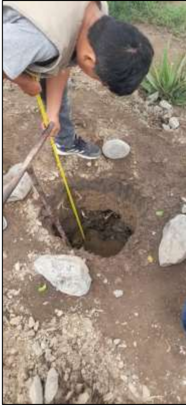
Medimos la profundidad y el nivel freático.
