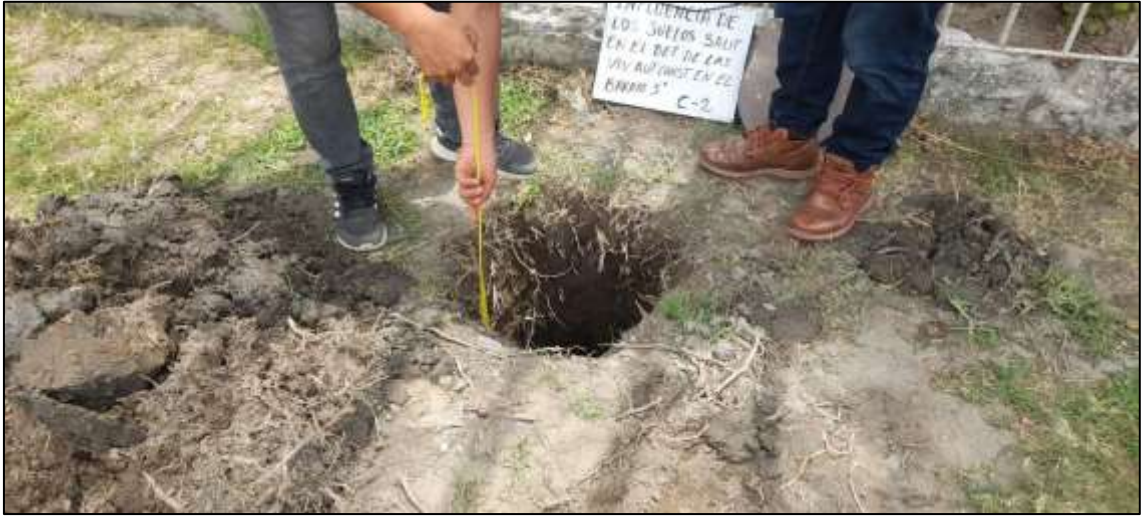
Medimos la profundidad de la calicata.
